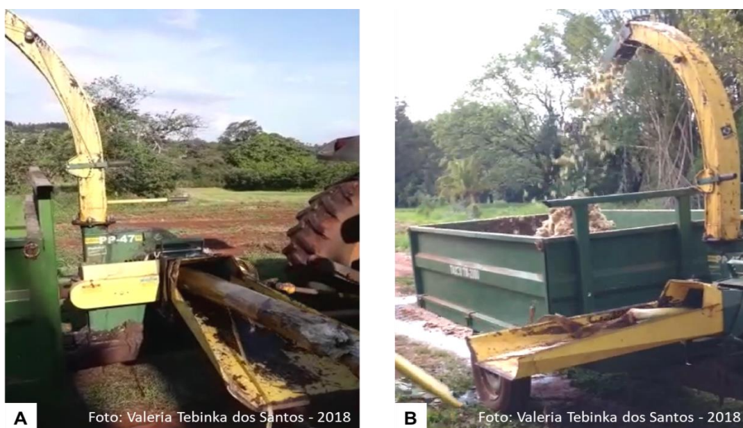
Figura 2 - Implemento acoplado ao trator para triturar pseudocaule de bananeira. Detalhe do compartimento de entrada do material vegetal inteiro ou pré-seccionado (A) e detalhe do compartimento de saída do material vegetal triturado (B). UNESP, Botucatu (SP), 2018
