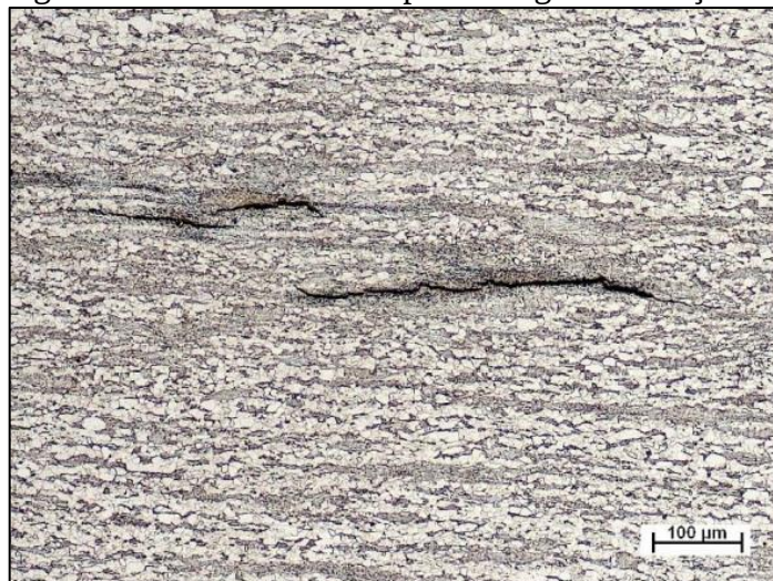
Figura 16 - Trinca induzida por hidrogênio em aço API
