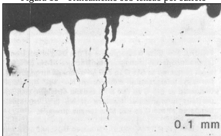
Figura 18 - Trincamento sob tensão por sulfeto
