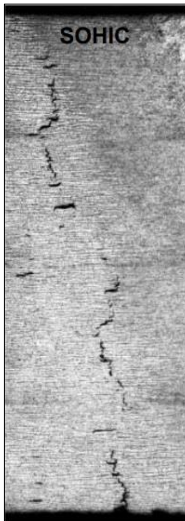
Figura 20 - Trincamento induzido por hidrogênio orientado sob tensão em uma estrutura metálica
