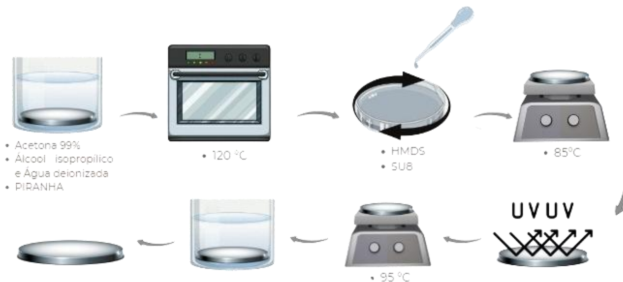
Figura 6 - Ilustração de como o molde no wafer de silício foi fabricado
