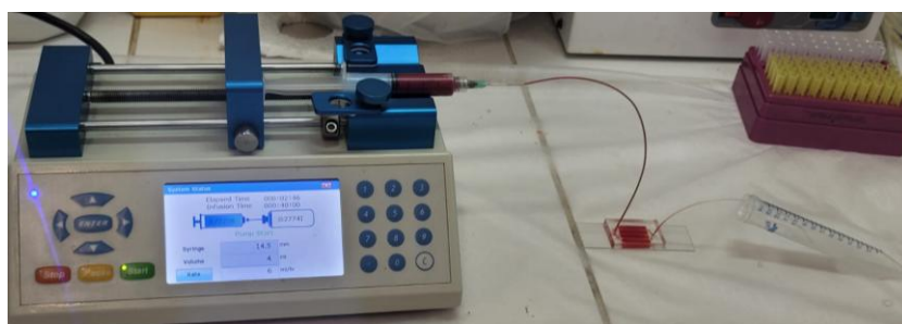
Figura 7 - Procedimento de funcionalização e passagem das células no dispositivo microfluídico
