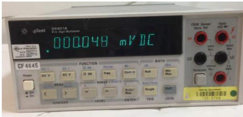
Figura 28 – Equipamento para a tomada de medidas elétricas com sonda de duas pontas utilizado na caracterização dos filmes sensores.
