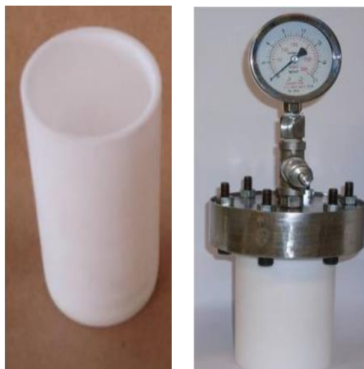
Figura 20 – Copo de teflon (a) e autoclave (reator hidrotérmico) com manômetro (b)
