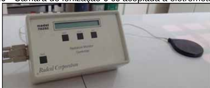
Figura 10 - Câmara de ionização 6 cc acoplada a eletrômetro Radcal
