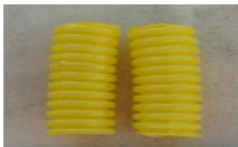
FIGURA 4. Fotos dos anéis de eletroduto corrugado (conduíte) utilizados como meio suporte nos reatores RAHLF (R1, R2, R3 e R4).
