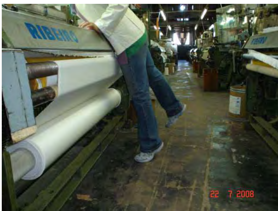
Figura 32 - Posição inadequada da operadora do tear.
