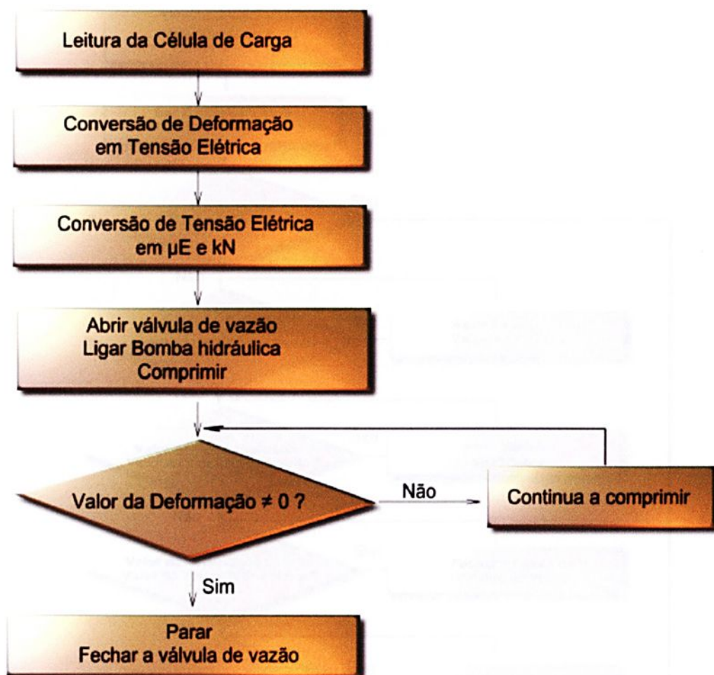
Figura 33 - Fluxograma de ajuste do pistão do cilindro de carga
