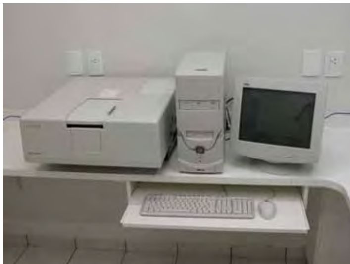
FIGURA 8 - Espectrofotômetro de Reflexão Ultravioleta Visível, Modelo UV-2450 (Shimadzu, Japão)
