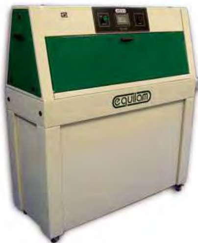
FIGURA 7 - Câmara de envelhecimento acelerado para não-metálicos (Equilam, Brasil)
