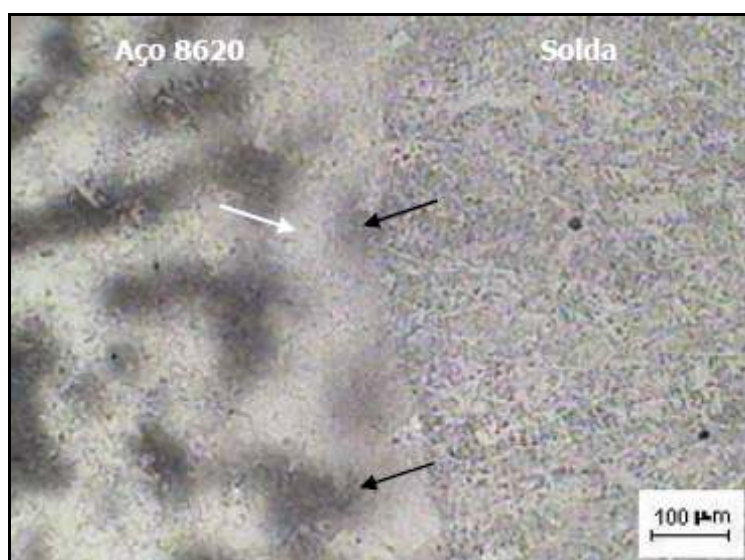
Figura 5.11 – Micrografia A de corpo de prova soldado com temperatura de pré-aquecimento de 120°C e sem tecimento.
