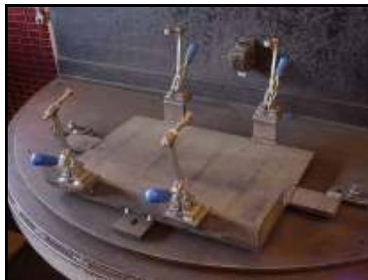
Figura 4.5 – Dispositivo de Soldagem.
