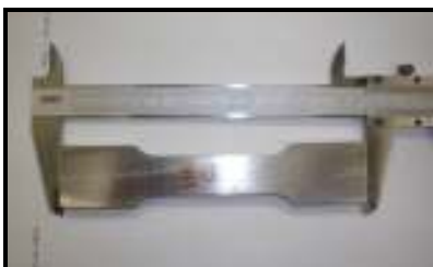
Figura 4.22 – Corpo de prova para ensaio de tração.
