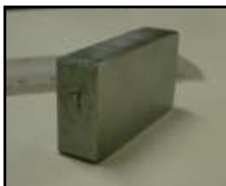
Figura 4.23 – Corpo de prova para análise metalográfica.
