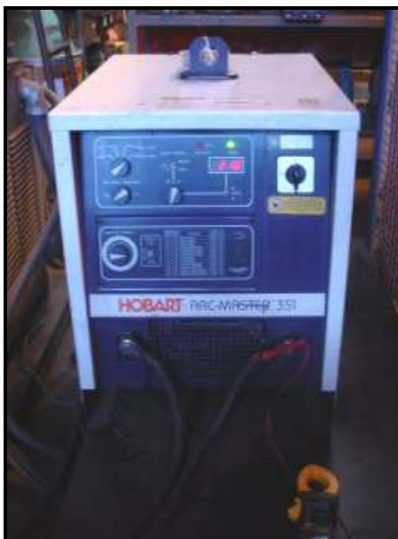
Figura 4.2 – Fonte de Soldagem Hobart ARC-MASTER 351.
