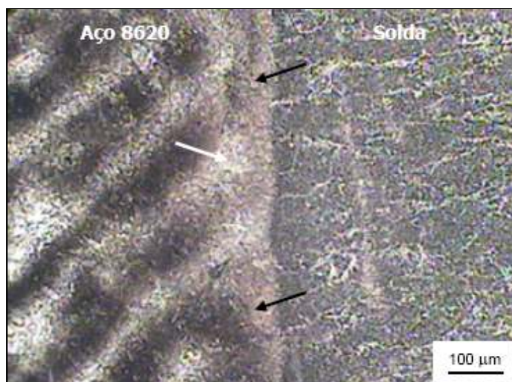
Figura 5.1 – Micrografia A de corpo de prova soldado a temperatura ambiente e tecimento ZIGZAG.
