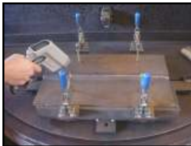
Figura 4.14 – Medição de temperatura interpasses.
