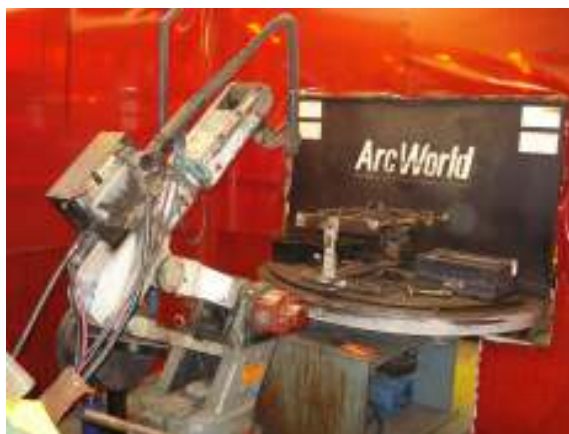
Figura 4.1 – Esquema da célula de soldagem robotizada ArcWorld 1000.
