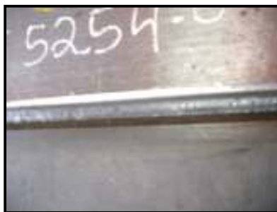
Figura 4.19 – Corpo de prova após a execução do primeiro passe de soldagem ou passe de raiz.
