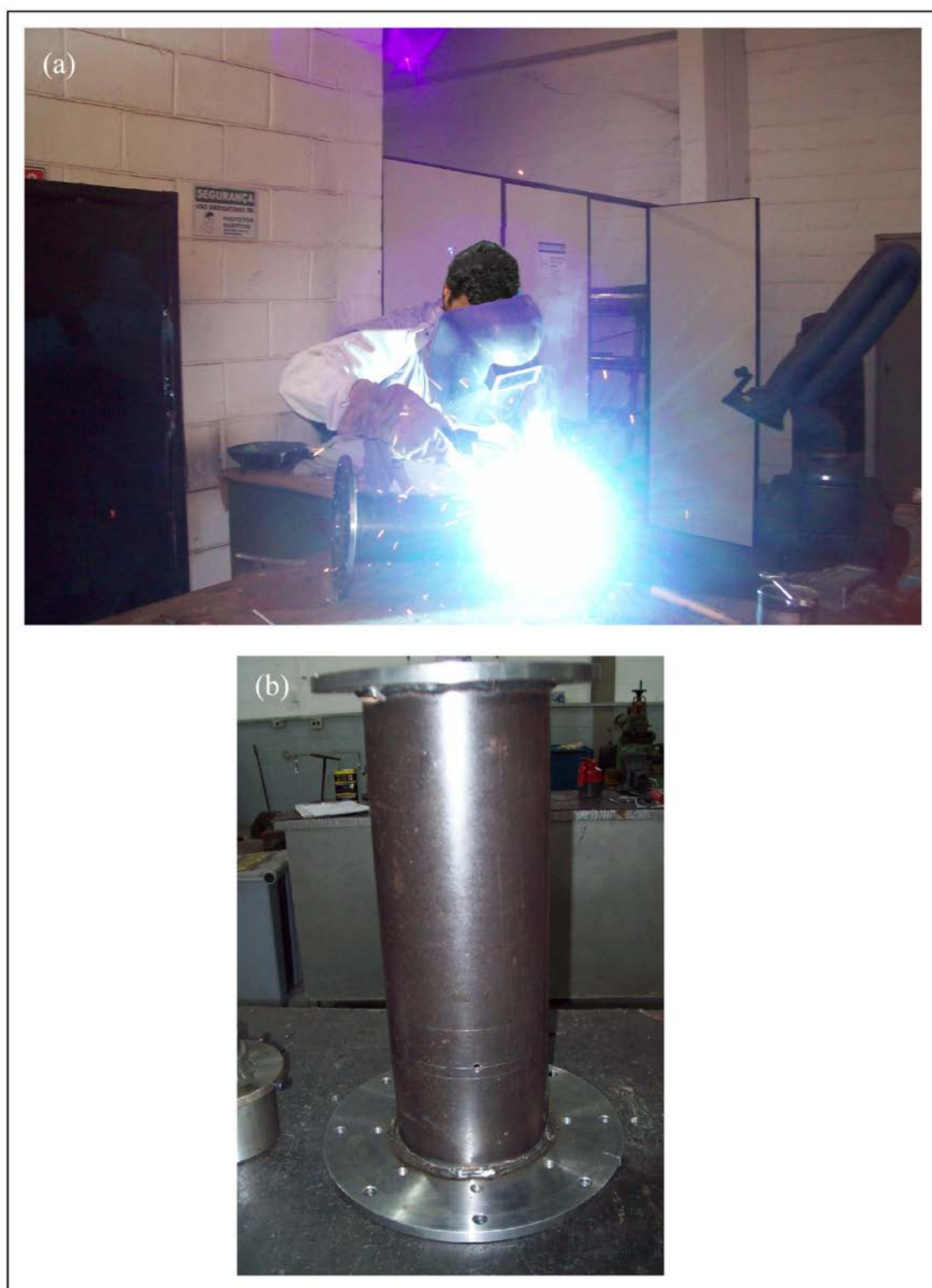
Figura 125 - Tubo Camisa da Mola – (a) Processo de fabricação (soldagem), (b) Produto acabado.
