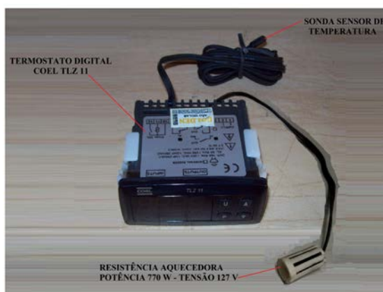
Figura 51 - Sistema de Aquecimento do Fluido Lubrificante da Câmara de Ensaio.
