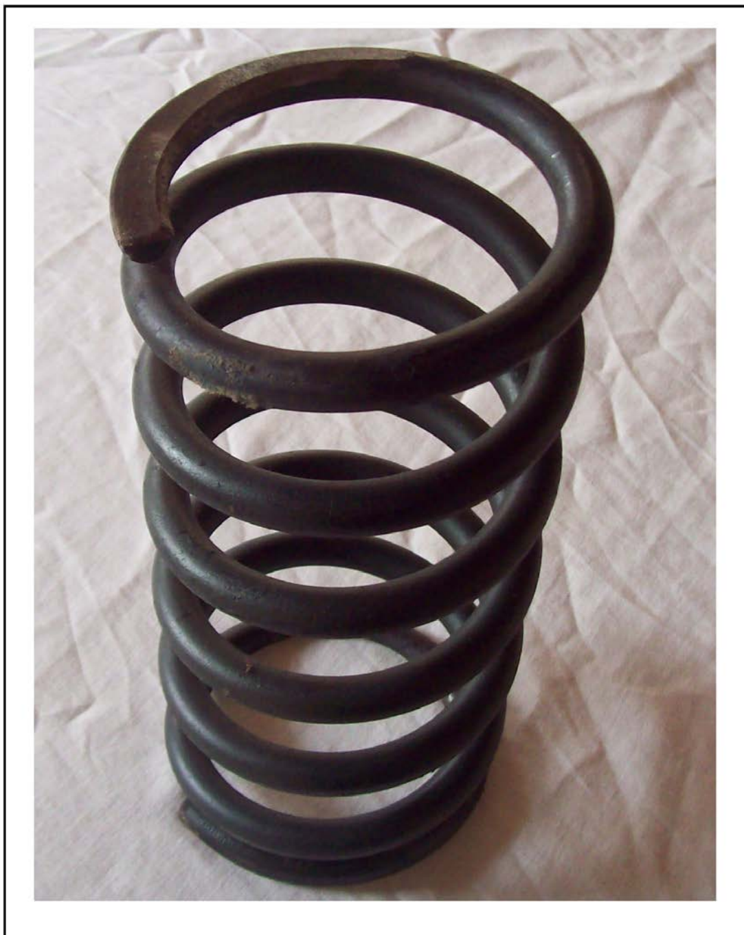
Figura 126 - Mola de Compressão - (diam. do arame: 14,16 mm, diâm. ext.: 123,66 mm, comp.: 271 mm, k = 4,6 \text{ kgf/mm} ).
