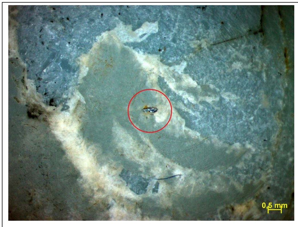
Figura 68 - Detalhe da região delaminada com resíduo de cavaco metálico (sugerido) incrustado no centro (indicado) e alguns pigmentos não identificados no entorno.
