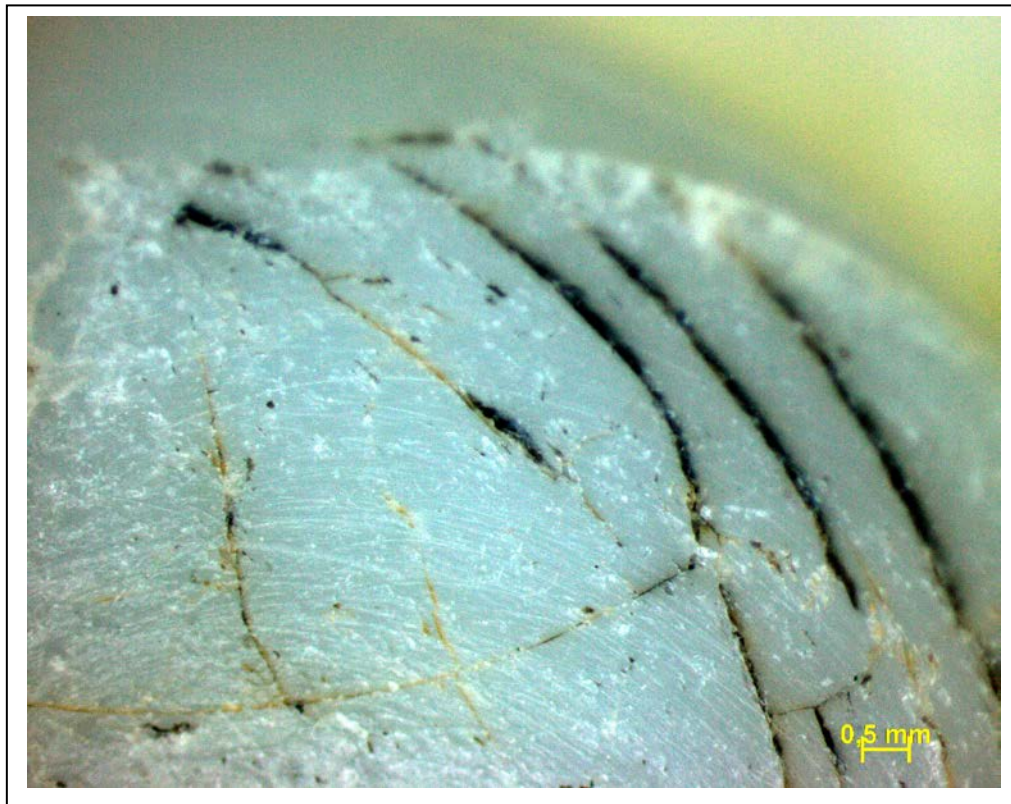
Figura 70 - Superfície acetabular com sulcos, caracterizando o processo de desgaste por abrasão.
