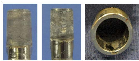
Figura 30 - Mecanismo de desgaste corrosivo.
