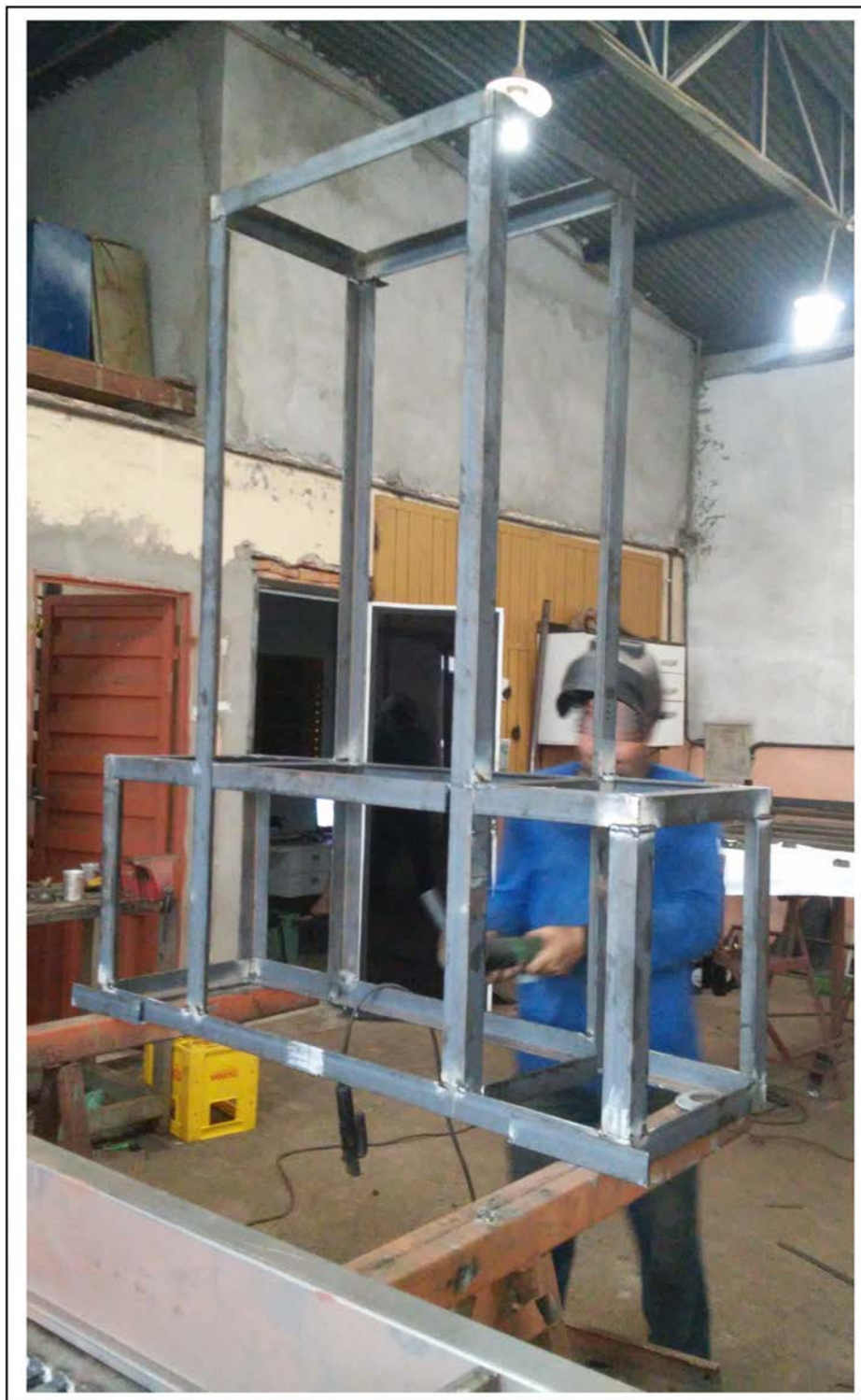
Figura 118 - Estrutura (rack) – Processo de fabricação.
