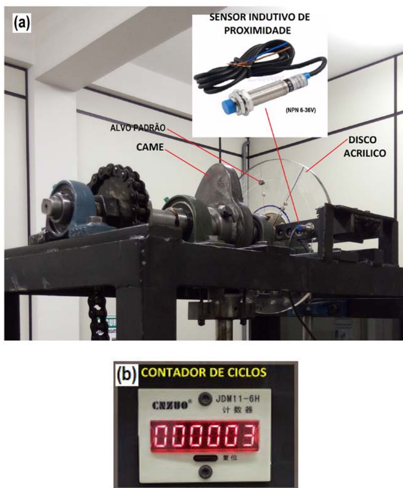
Figura 52 - Sistema de contagem de ciclos: (a) sensor indutivo, (b) contador de ciclos.
