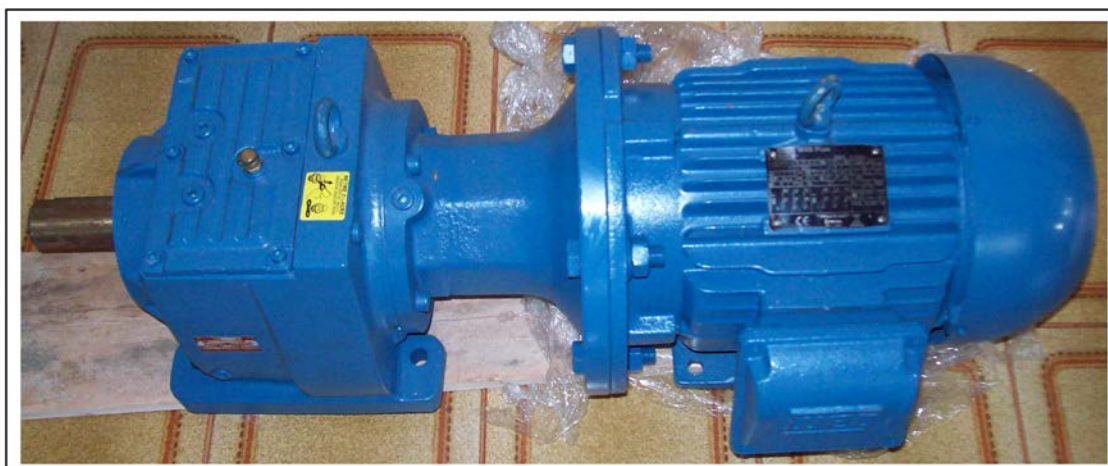
Figura 138 - Motoredutor 4CV - 1750 rpm/70 rpm.
