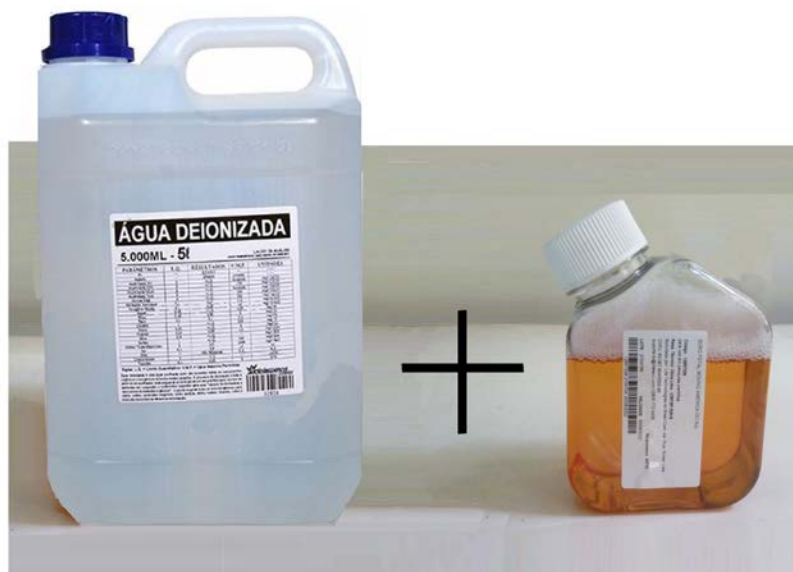
Figura 62 - Composição do Fluido lubrificante (Água Deionizada + Sêro Fetal Bovino).
