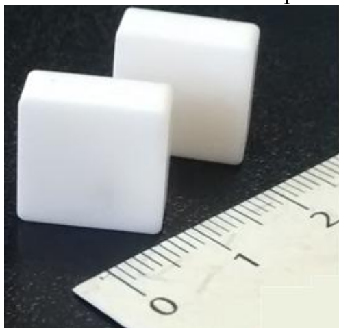
Figura 33: Ferramenta de alumina utilizada no processo de usinagem
