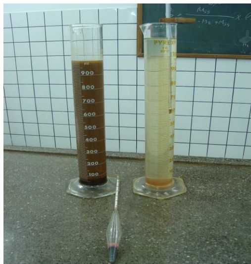
Figura 11: Determinação da composição granulométrica da fração fina do lodo.
