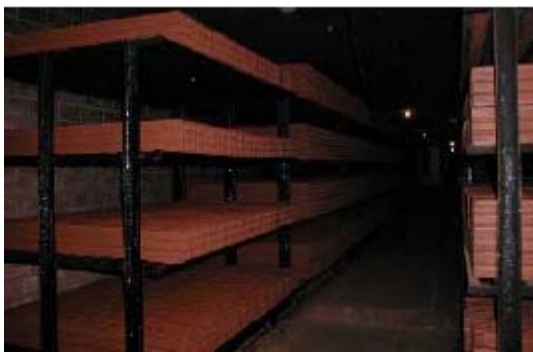
Figura5: Peças cerâmicas dispostas em prateleiras em galpões cobertos e secas pelo ar ambiente
