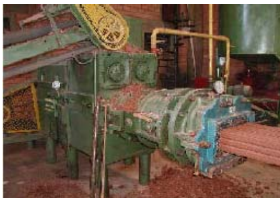
Figura 4: Processo de extrusão durante a fabricação de tijolos em olaria.
