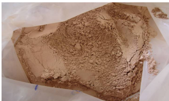
Figura 3: Argila coletada da jazida da Olaria Ivanira e moída em moinho de martelo em malha ABNT 32 (abertura 0,5mm).
