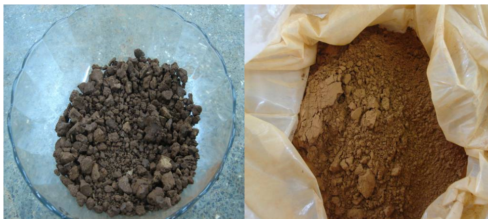
Figura 13: Amostra de lodo antes e depois de passar pelo moinho.
