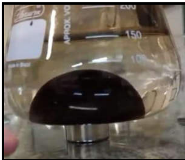
Figura 35: NPM em solução aquosa respondendo ao campo magnético do ímã, confirmando suas propriedades magnéticas
