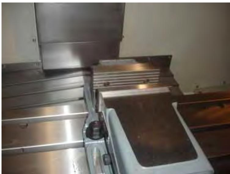
Figura 12 – Morsa e mordentes de fixação do centro de usinagem CNC.
