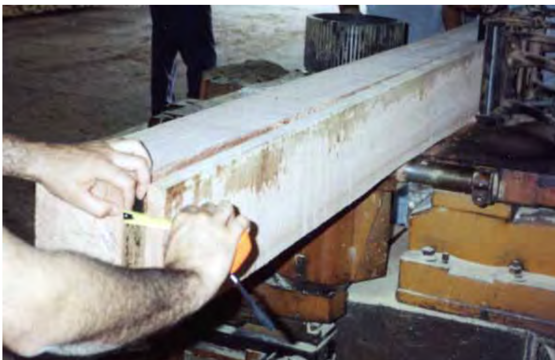
Figura 16. Medição da abertura da tábua em relação ao bloco no desdobro.
