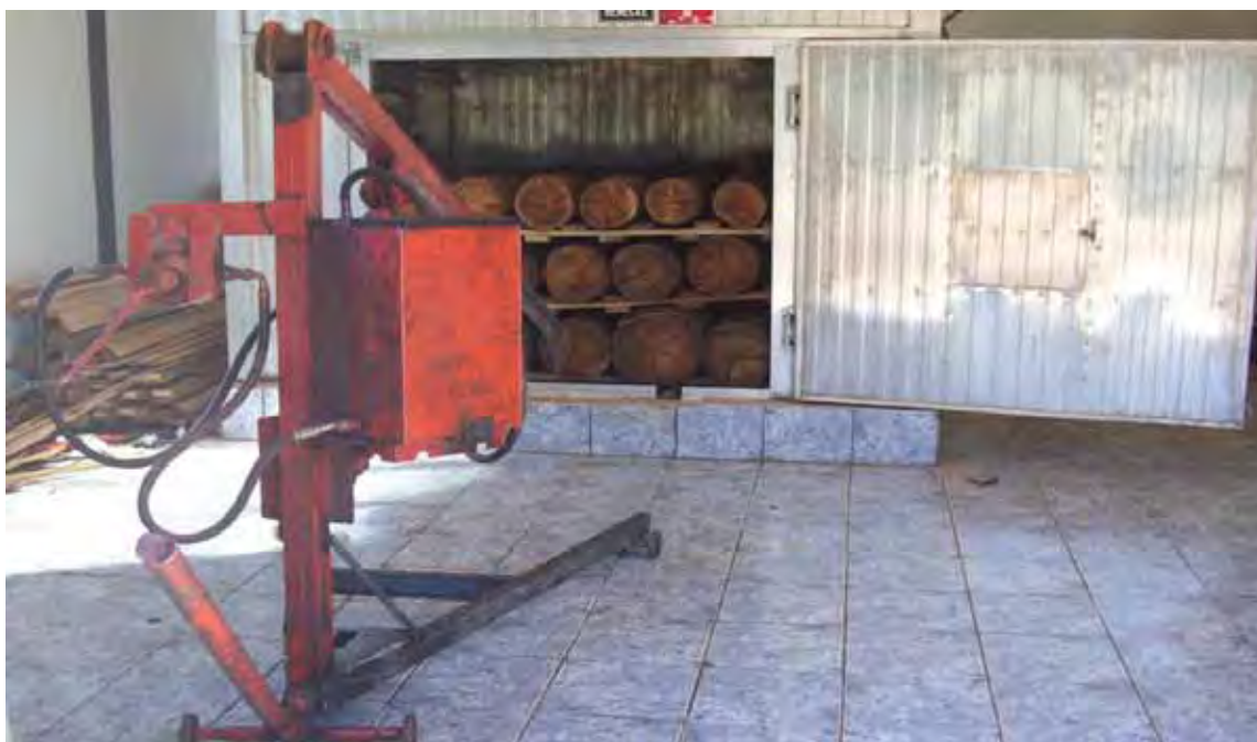
Figura 11. Guincho utilizado para a colocação das toras no meio vaporizador.
