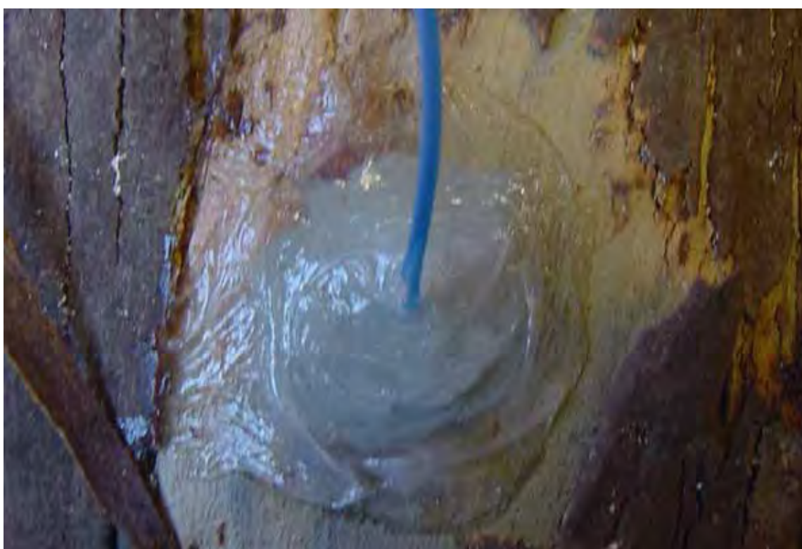
Figura 10. Termopar inserido na tora de Eucalyptus grandis .
