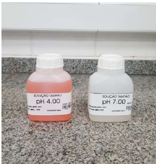
Figura 7 – Soluções tampão de pH 4,00 e 7,00 para calibração do pHmetro.
