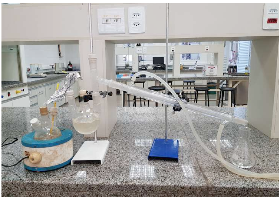
Figura 11 – Conjunto de destilação por arraste a vapor do vinagre de cerveja.
