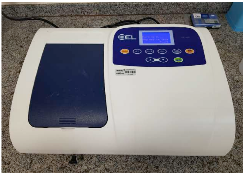
Figura 8 – Espectrofotômetro UV-vis para análise da densidade óptica do vinagre de cerveja.
