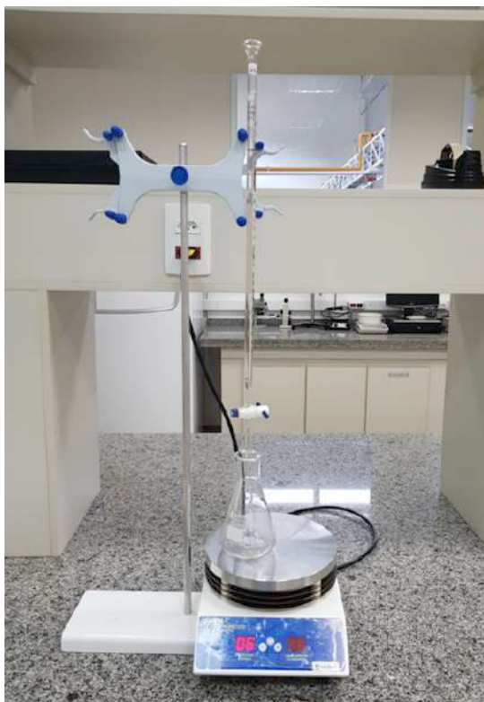
Figura 10 – Conjunto de titulação ácido oxálico-NaOH.
