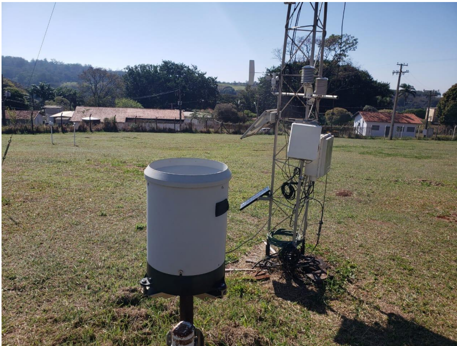
Figura 4 – Pluviômetro presente na estação meteorológica automatizada da Fazenda Lageado Botucatu, São Paulo
