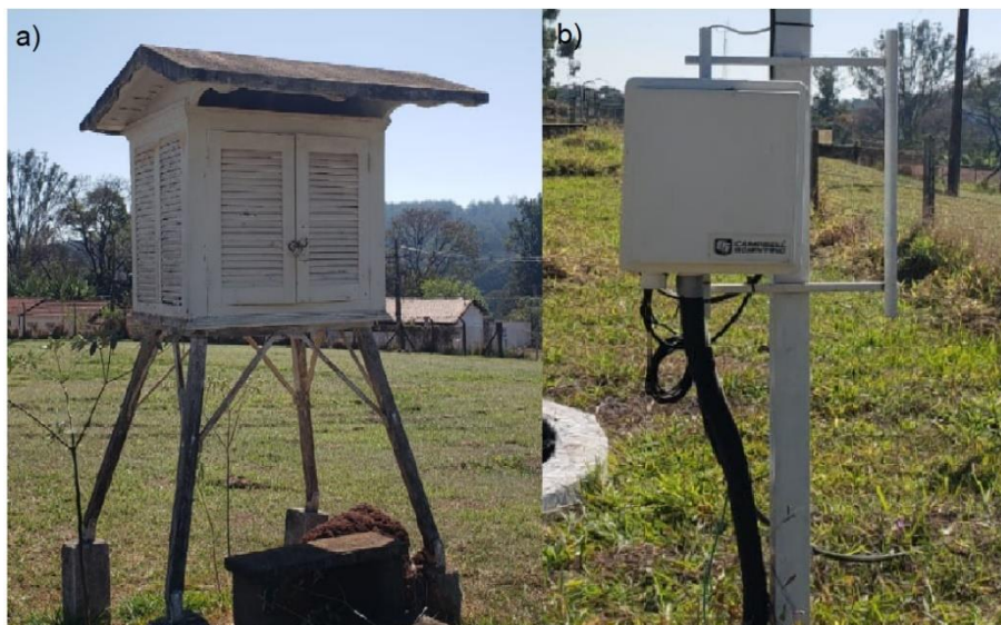
Figura 1 – Abrigo Convencional e Automatizado da Estação Meteorológica da Fazenda Lageado Botucatu, São Paulo
