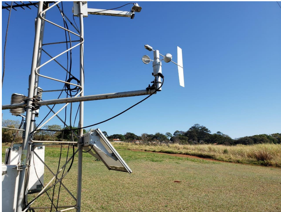
Figura 3 – Anemômetro presente na estação meteorológica automatizada da Fazenda Lageado Botucatu, São Paulo
