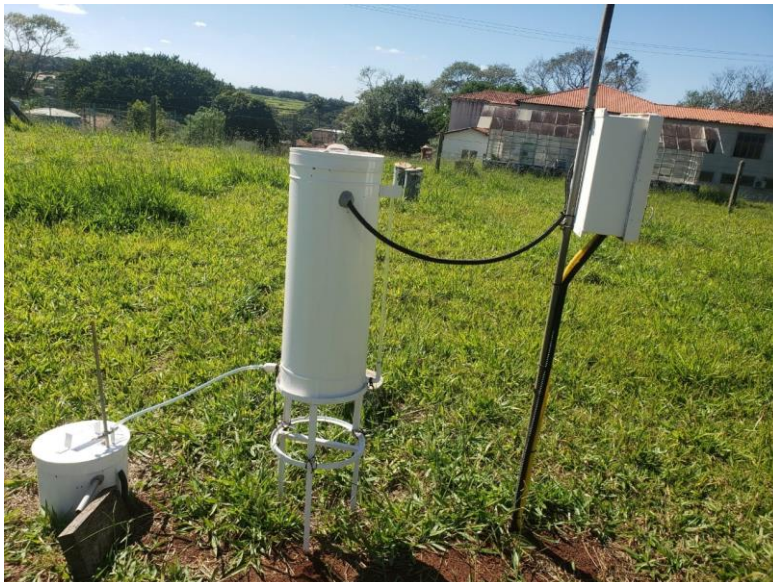
Figura 10 – Lisímetro de Lençol Freático Constante Presente na Estação de Lisimetria na Fazenda Lageado Botucatu, São Paulo
