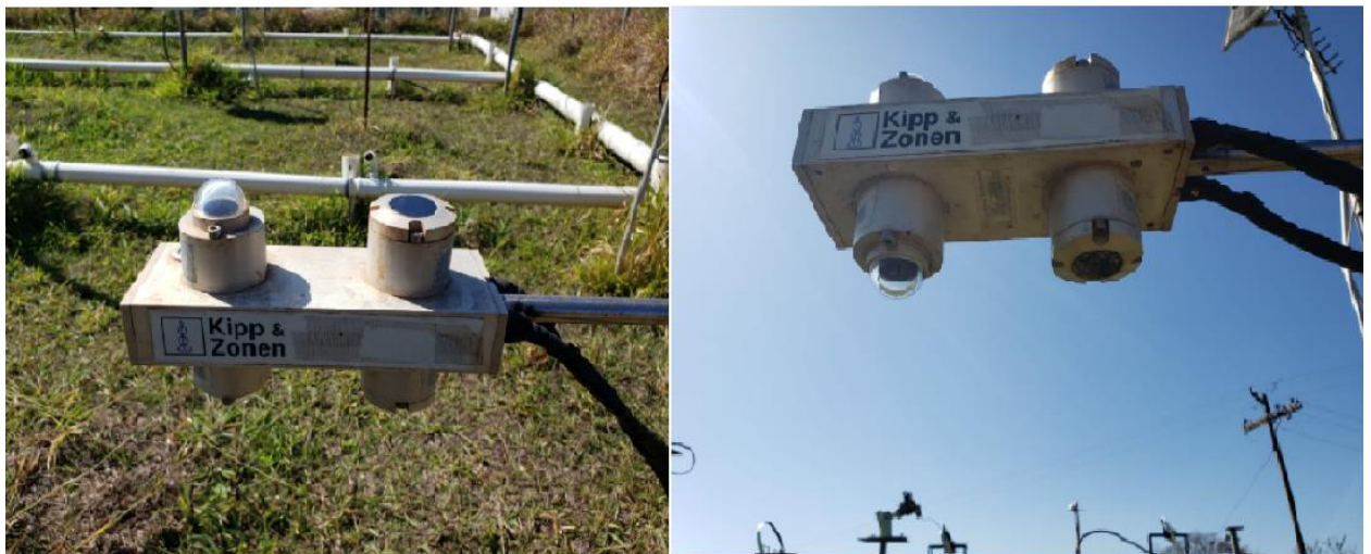
Figura 5 – Radiômetro CNR1 presente na estação de radiometria solar da Fazenda Lageado Botucatu, São Paulo
