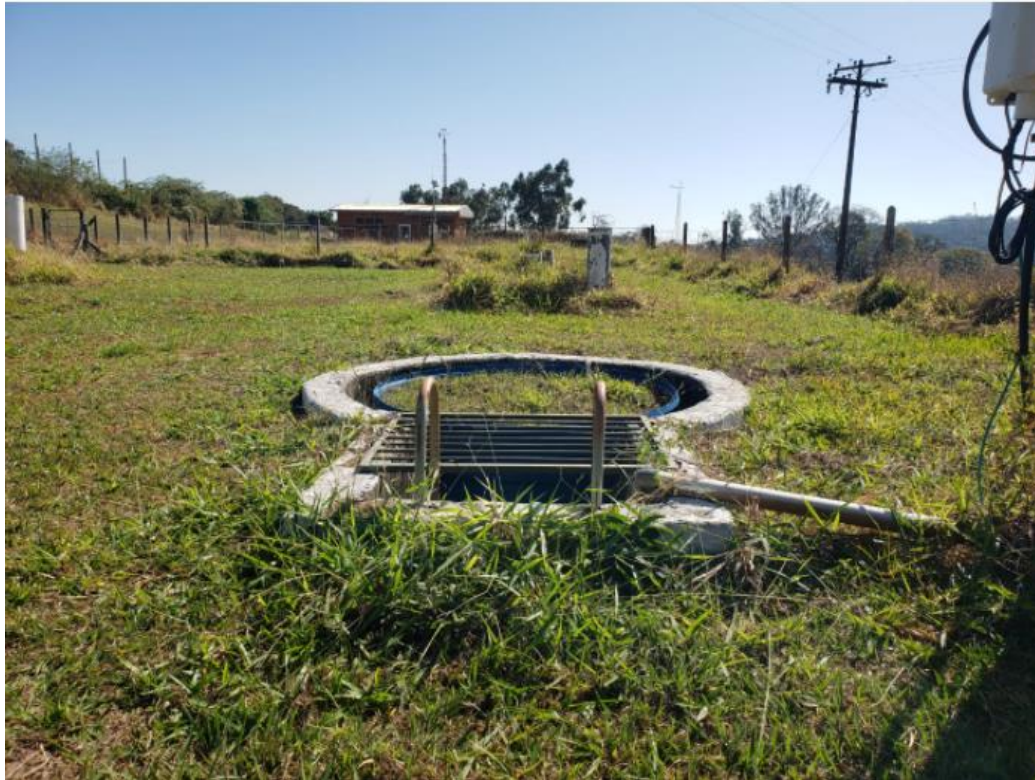
Figura 7 – Lisímetro de pesagem presente na estação de lisimetria da Fazenda Lageado Botucatu, São Paulo
