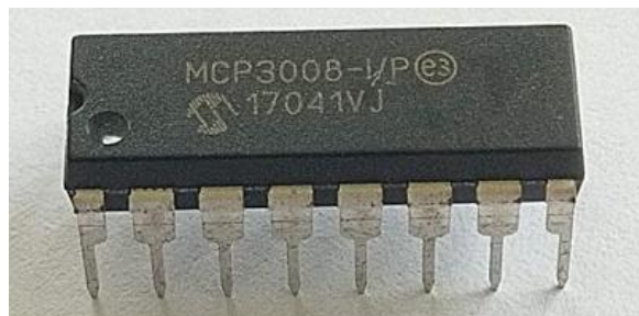
Figura 30 – Conversor de sinais analógicos para digitais de 8 canais com resolução de 10 bits - MCP3008
