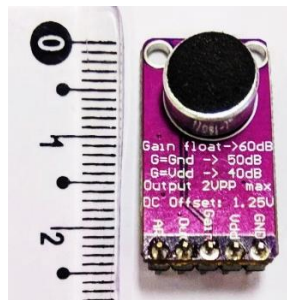
Figura 28 – Sensor para captação da emissão acústica – MAX9814.
