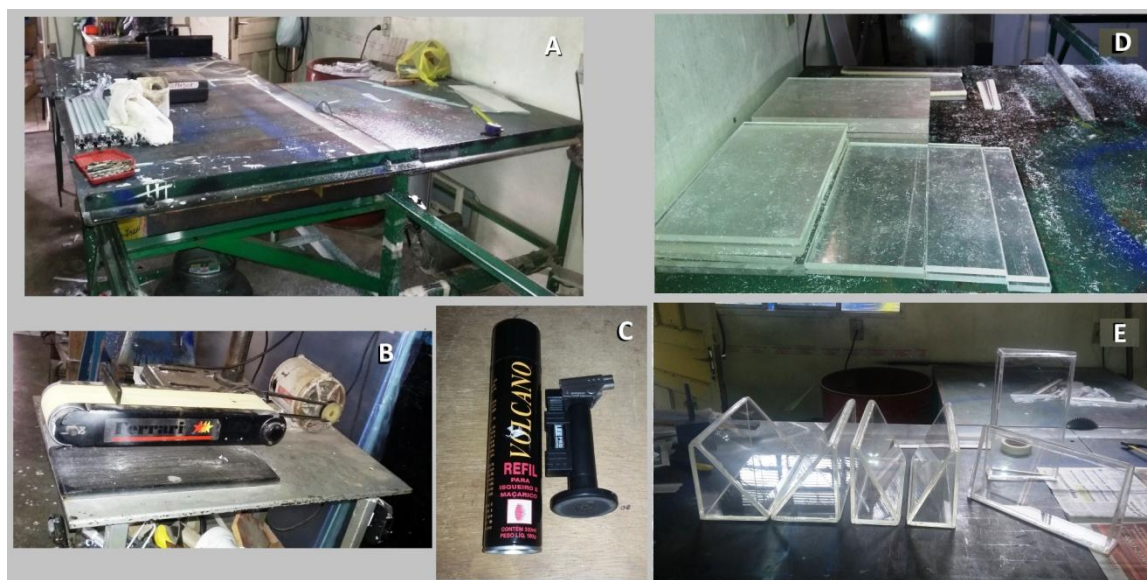
FIGURA 53 Serra esquadrejadeira adaptada para cortar o acrílico (A), lichadeira industrial de cinta (modelo Ferrari) usada para o lichamento (B), o massarico (Lee Pro Tools) e o refil do isqueiro (Volcano) utilizado no polimento (C) das partes do acrílico, todas as partes do acrílico divididas para a elaboração da cunhas (D) e os pares das cunhas 15^\circ , 10^\circ e 5^\circ finalizadas (E).
