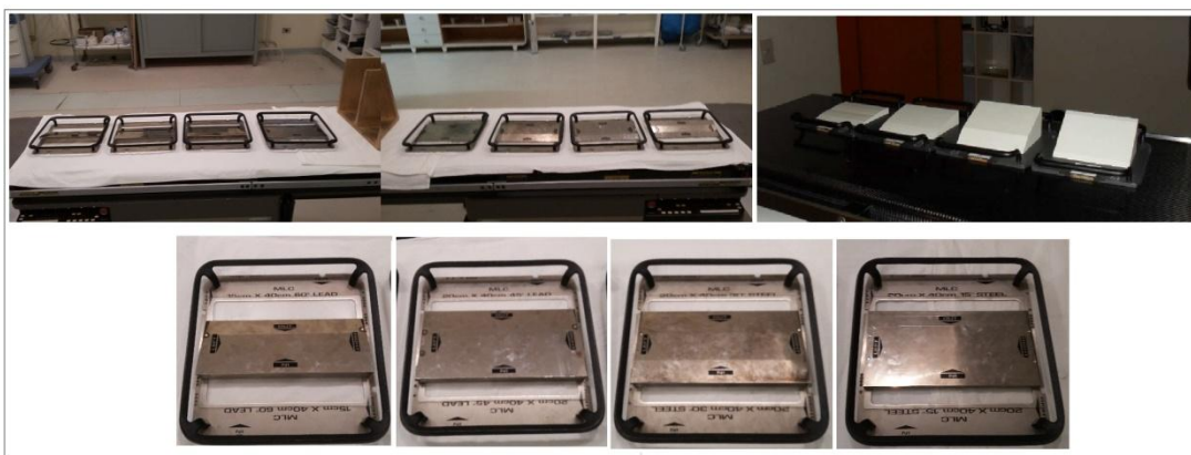
FIGURA 21 Modelos de filtros físicos em formato de cunha em diferentes tamanhos e angulações. Fonte: Adaptado de VETTORATO, 2016, SOUZA; CARDOSO; BATISTA, 2004.
