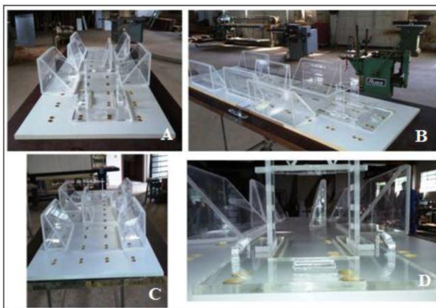
Figura 76. Acessórios de imobilização, os 3 pares de cunhas de acrílico (5° ,10° e 15°), a rampa com as 4 partes acopladas (F,M,V e Z) em (A, B e C), o suporte dentário, o regulador de altura (direito e esquerdo) para o molde dentário e a base de acrílico para a fixação da máscara termoplástica (D), sendo todos eles adaptados para diferentes anatomias de pequenos animais (cães e gatos).
