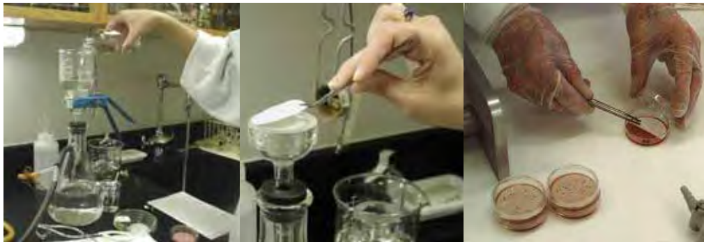
Fig.7. Procedimentos da técnica de Membrana Filtrante
