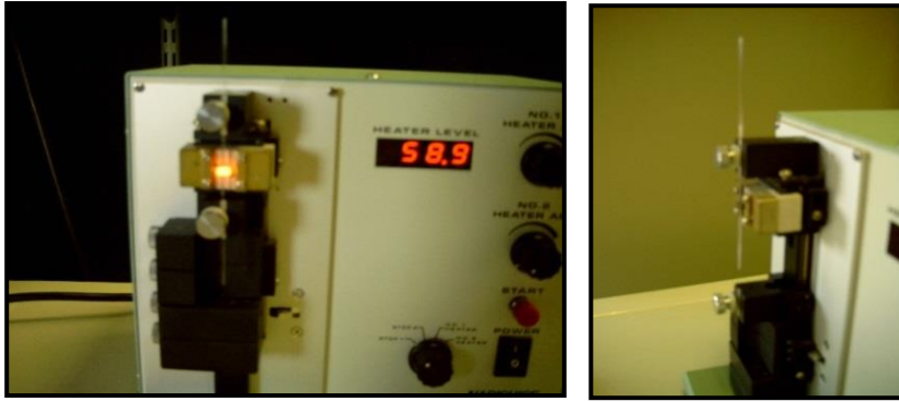
Figura 3. Equipamento utilizado na obtenção de agulhas para a realização da microdissecção cromossômica.
