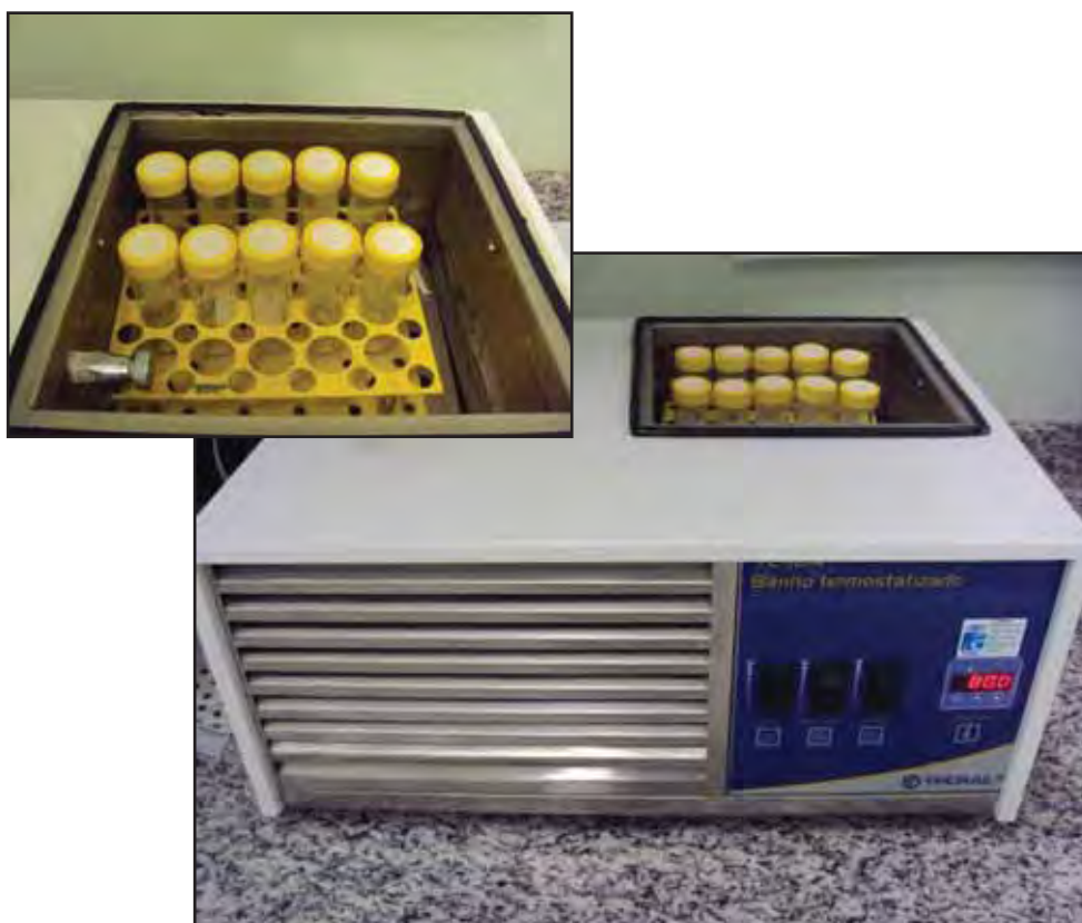
Figura 3.7 – Banho termostatzado mantido a 80°C por 1h.
