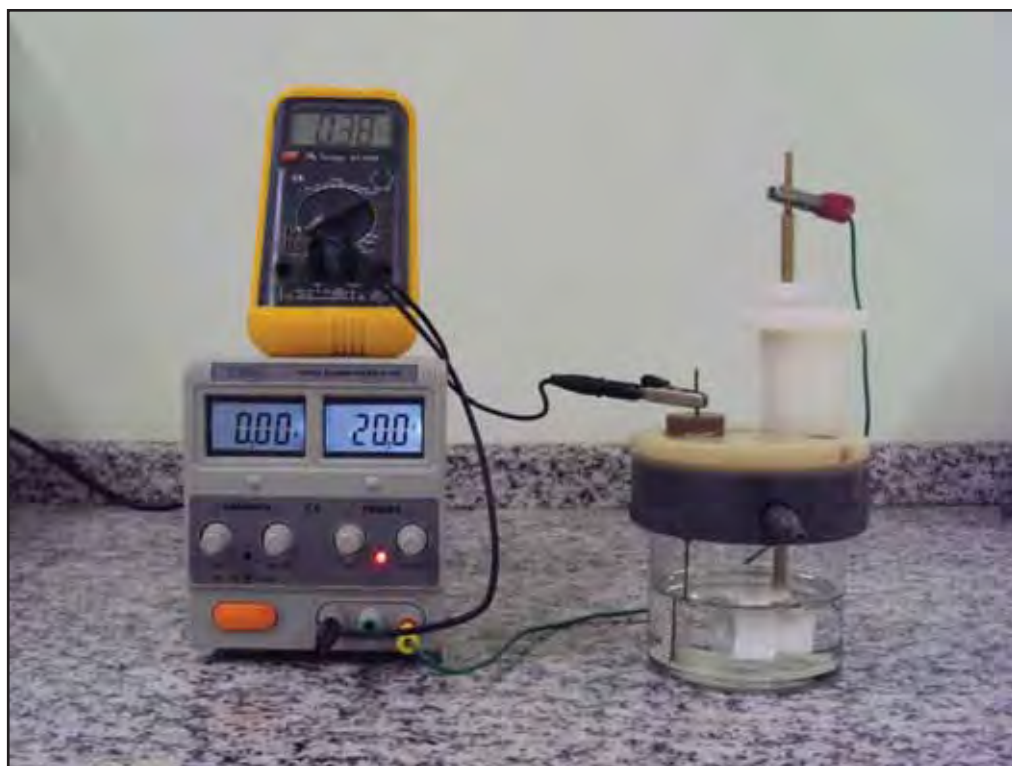
Figura 3.6 – Montagem da célula eletroquímica utilizada na anodização
