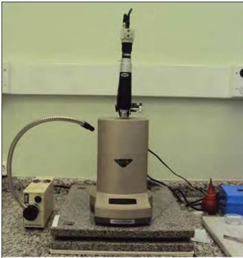
Figura 3.12- Microscópio de força atômica do Laboratório de Imagens de Materiais – Laboratório de Análise de Superfícies (LAIMat - LAS), da Faculdade de Engenharia de Guaratinguetá (FEG/UNESP)
