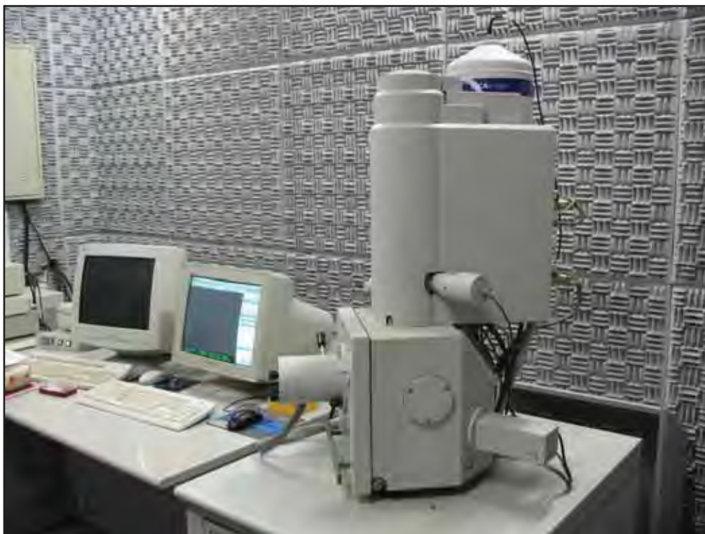
Figura 3.11- Microscópio eletrônico de varredura com filamento field emission gun (FEG)
