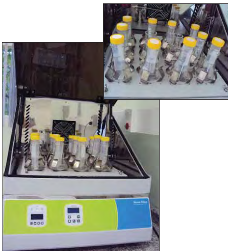
Figura 3.10 – Incubadora com agitação orbital refrigerada contendo os tubos Falcon
