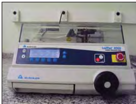
Figura 3.5– Máquina de corte empregada para obtenção dos discos após forjamento
