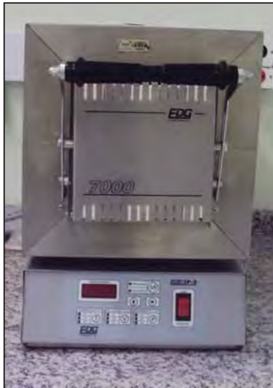
Figura 3.8 – Forno mufla EDG com aquecimento por resistência elétrica usado para tratamento térmico das amostras
