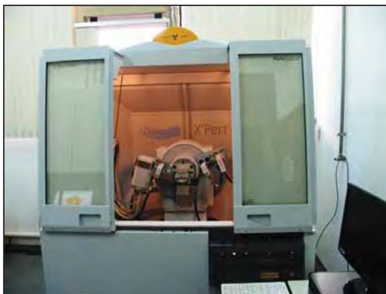
Figura 3.14 – Difratorômetro de raios X, Panalytical X'Pert empregado nas análises de raios X
