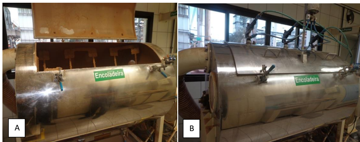
Figura 17. Processo de encolagem das fibras com os adesivos e aditivos – vista interna da encoladeira (A), vista geral da encoladeira com o sistema de aspersão (B)
