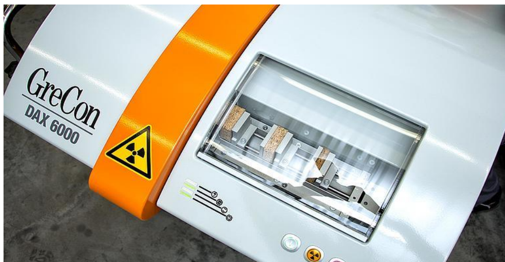
Figura 31. Equipamento utilizado na realização do ensaio de análise dos perfis de densidade
