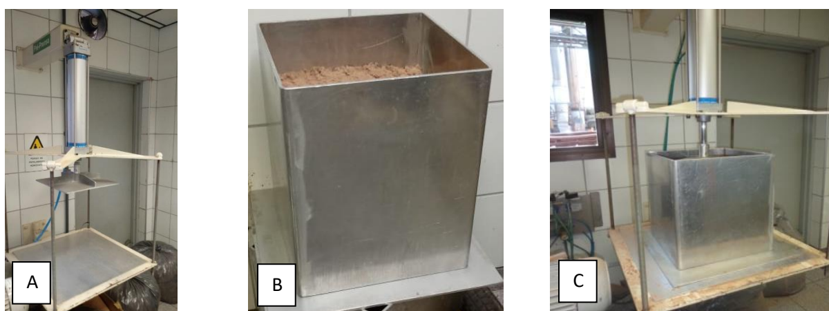
Figura 18. Dispositivo pneumático de pré-prensagem (A), acondicionamento de forma uniforme no dispositivo da pré-prensa (B), e a pré-prensagem pelo cilindro pneumático (C)
