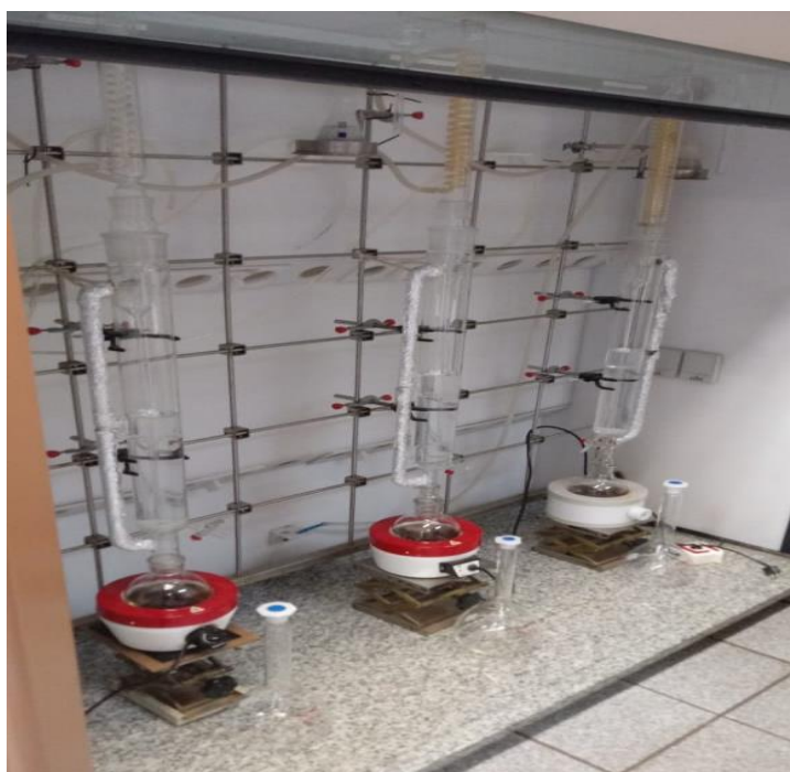
Figura 30. Dispositivos para realização do ensaio de emissão de formol pelo método Perforator
