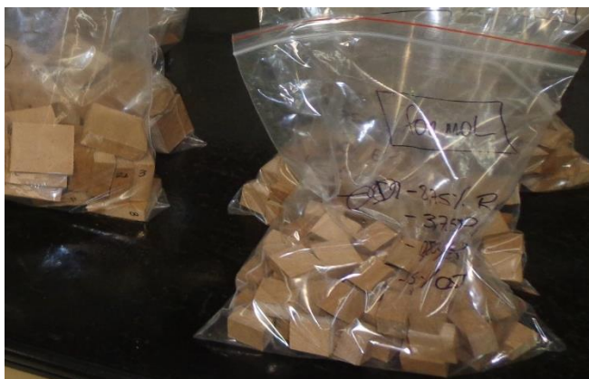
Figura 23. Parte dos corpos de prova de MDF fabricados para testes exploratórios
