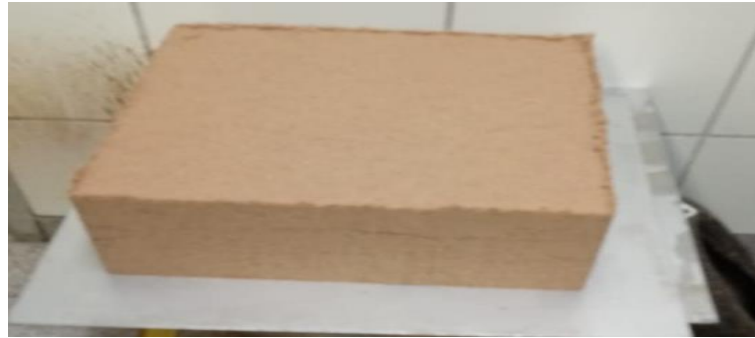
Figura 19. Colchão de fibras encoladas pré-prensado
