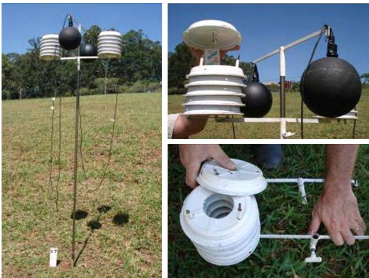
Figura 8. Vista geral do suporte com os equipamentos e detalhes do abrigo do mini-datalogger.
