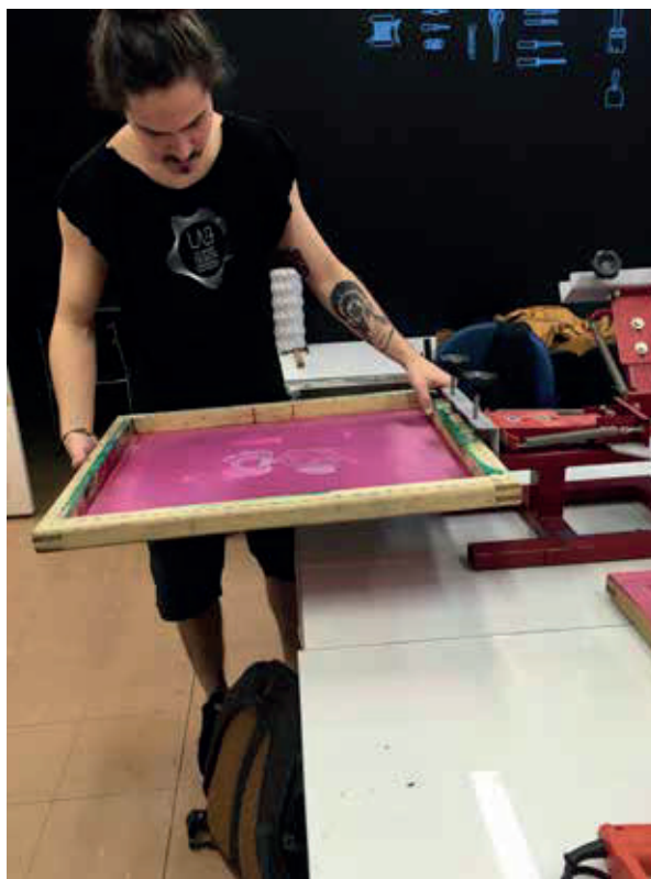
FIGURA 48. Encaixando a matriz no berço para início do processo de est amparia.
