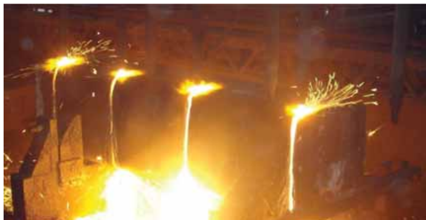
Figura 18 - Corte a quente do lingote. Foto cedida pela MWL Brasil.
