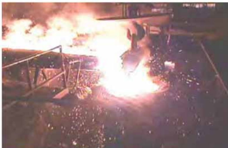
Figura 14 - Vazamento do aço do forno elétrico para a panela durante sua preparação.
