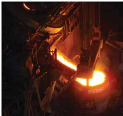
Figura 17 - Vazamento do aço na aciaria. Foto cedida pela MWL Brasil.
