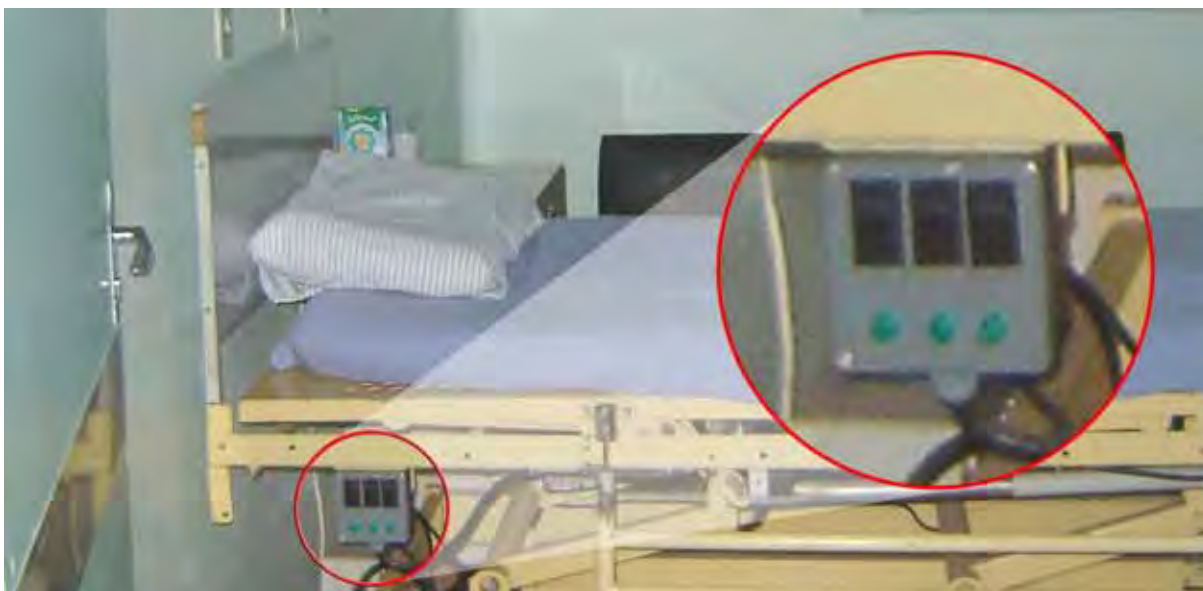
Figura 5.23 - Leito com controle de ajuste automático evidenciando a falta de informações.
