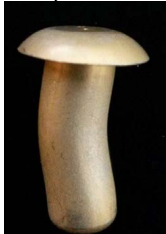
Figura 9: Instabilidade na compressão de rebite de cabeça protuberante
