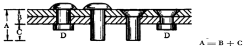
Figura 4: Determinação do comprimento do rebite
