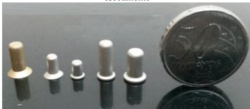
Figura 8: Rebites utilizados no ensaio de compressão para levantamento da curva de escoamento
