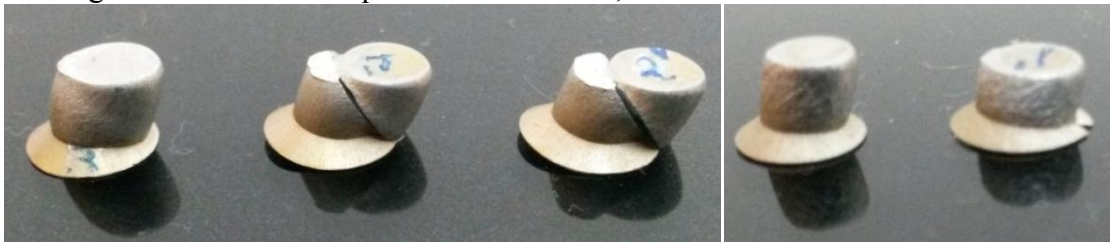
Figura 11: Rebites comprimidos inclinados, devido ao revestimento de PTFE
