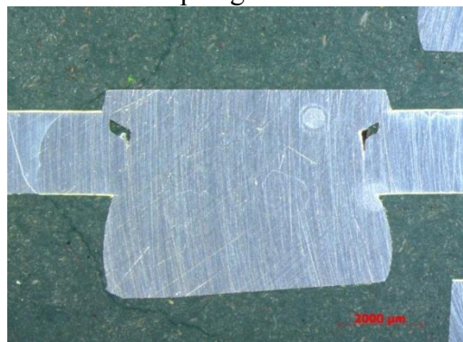
Figura 52: Rebite escareado com diâmetro expandido a 5,7 mm, cravado em furo 7/32 polegadas
