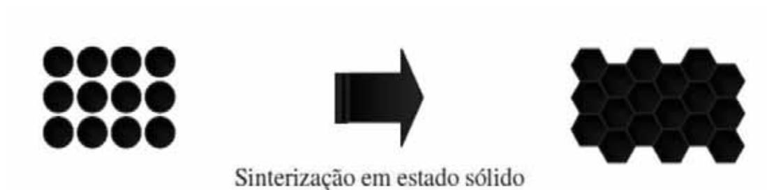
**Figura 9 . Ilustração do processo de sinterização do estado sólido (Adaptado de LIMA, 2006).**
