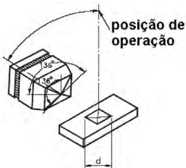
Figura 17. Formato do penetrador no ensaio de dureza Vickers (BURGER et al, 2006).
