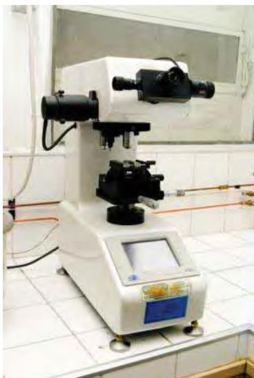
**Figura 18. Digital Micro Hardness Tester, equipamento utilizado para medidas de dureza.**
