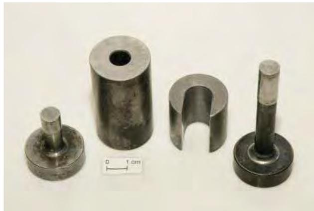
Figura 14. Molde utilizado para a compactação das cerâmicas.
