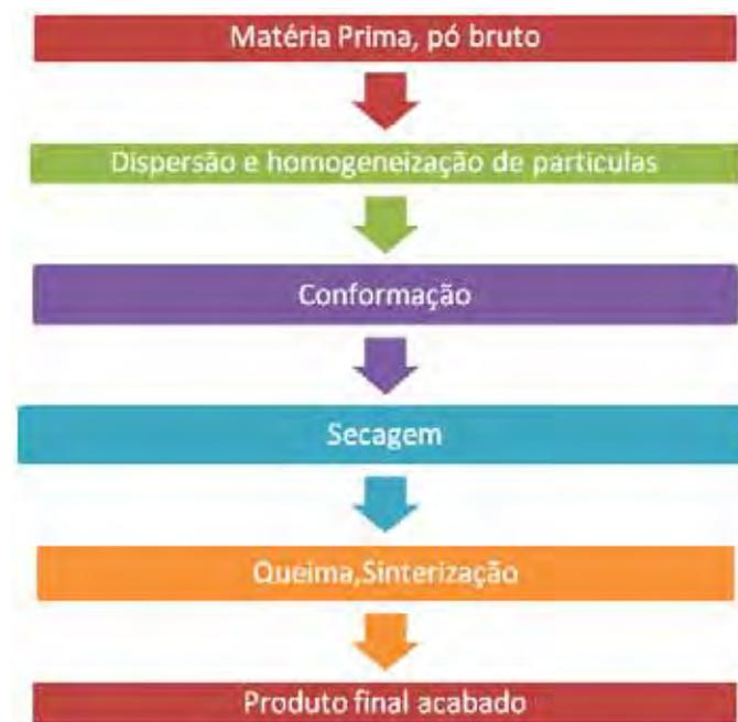
Figura 8. Fluxograma ilustrando o processo de conformação de materiais cerâmicos (PANDOLFELLI et al.,2000).
