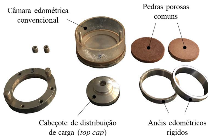
Figura 46. Materiais usados na montagem do ensaio edométrico convencional.
