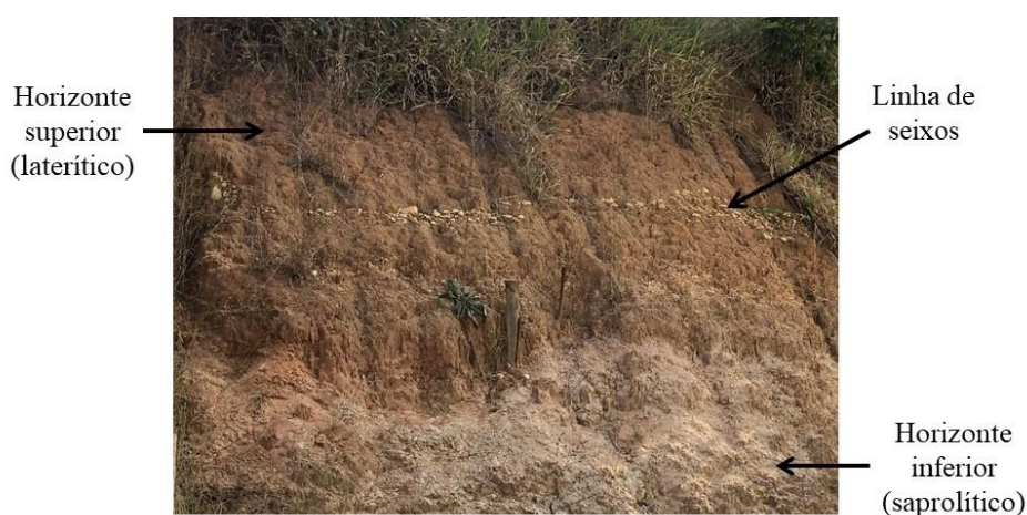
Figura 3. Linha de seixos separando o horizonte superior (laterítico) do horizonte inferior (saprolítico).
