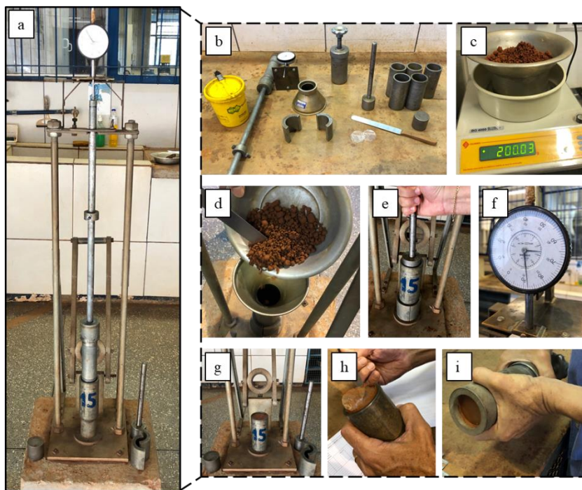
Figura 44. Sequência e equipamentos utilizados no ensaio de compactação mini-MCV: (a) montagem; (b) e (c) equipamentos; (d) e (e) moldagem; (f) medidor de deslocamento vertical; (g), (h) e (i) extração.
