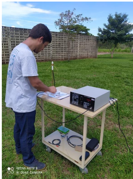
Figura 54 - Operador em determinação do diagrama de irradiação da antena ground-plane .
