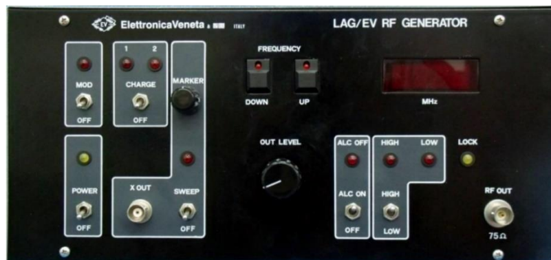
Figura 32 - Gerador de RF do kit didático ElettronicaVeneta
