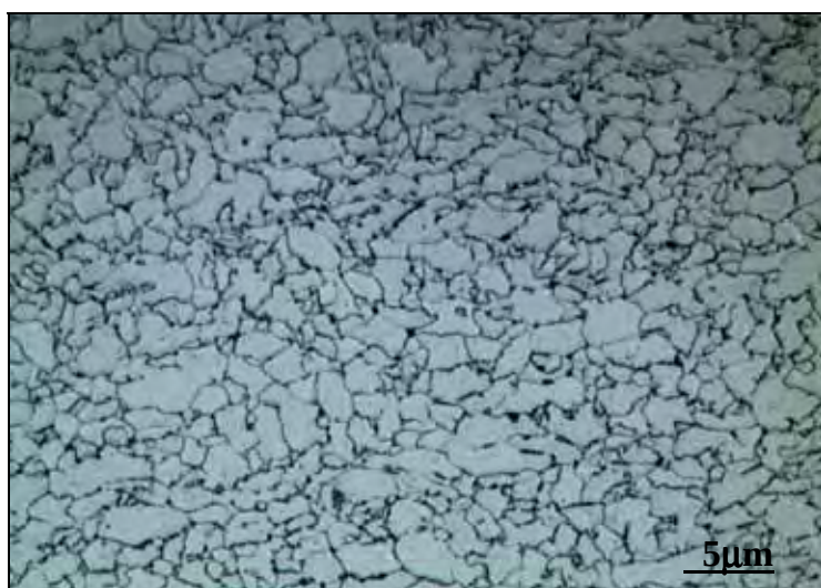
Figura 5.1: Fotomicrografia obtida por MO do material tratado na condição Mult 800 10. Ampliação de 500X. Ataque químico: Nital 2%.
