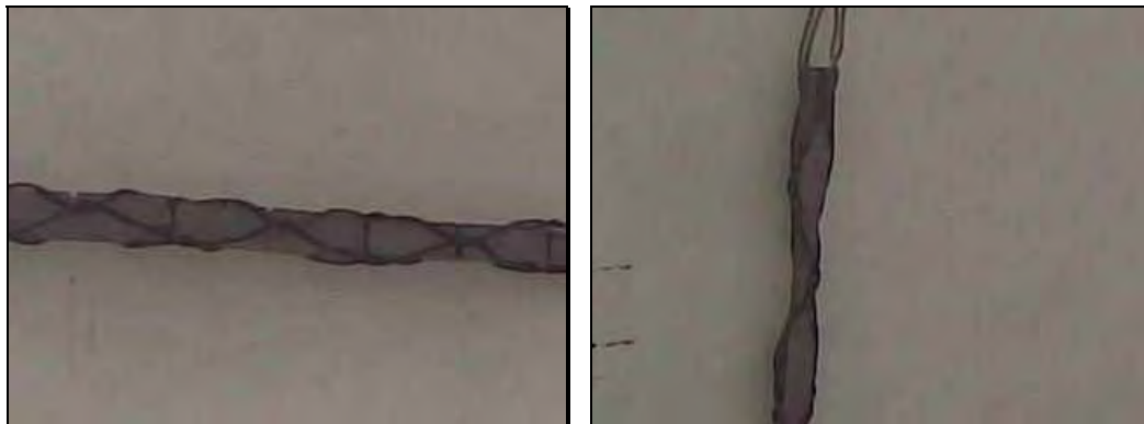
Figura 4.6: Amostras amarradas para tratamento térmico: a amostra da esquerda para o ensaio de impacto e a da direita para o ensaio de tração.
