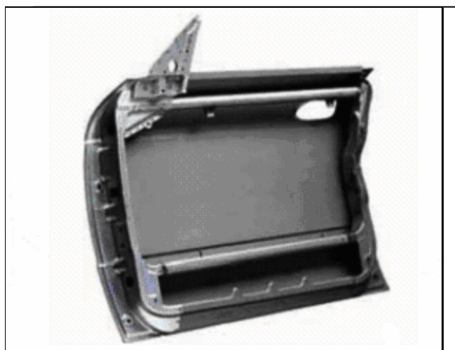
Figura 1.2: Porta produzida no projeto ULSAC para demonstração dos conceitos desenvolvidos (adaptada de ULSAB-AVC OVERVIEW REPORT, 2002).
