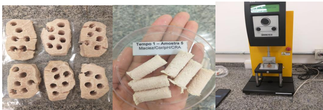
Figura 4: Longissimus o cozido e retirado as sub-amostras; Sub- amostras prontas; Texturômetro CT3 (Brookfeld) Corte com lâmina Warner-Bratzler.
