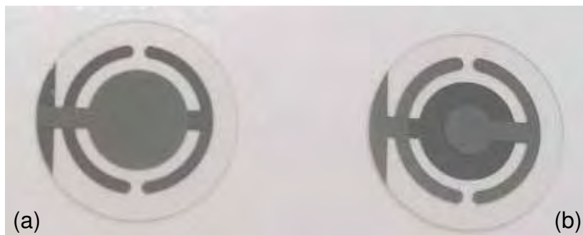
Figura 3.1: fotografias de ambas as faces do cristal de quartzo utilizado nesse trabalho. O filme de platina da foto (a) é o da área ativa do cristal e de (b) é o que fez contato com o circuito eletrônico.
