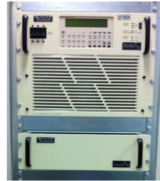
Figura 2. Fonte programável utilizada nos ensaios.
