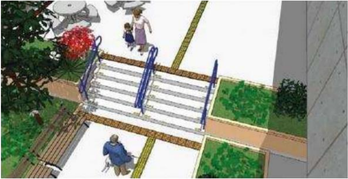
Figura 12 – Exemplo de sinalização tátil antes da escada
