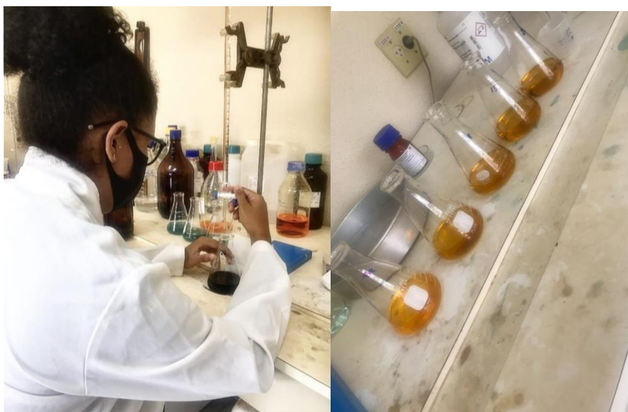
Figura 3. Determinação de carbono orgânico total por oxidação com mistura de dicromato de potássio + ácido sulfúrico.
