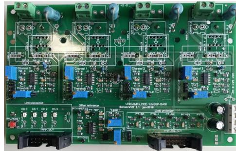
(b) Visão frontal - Circuitos de condicionamento.
