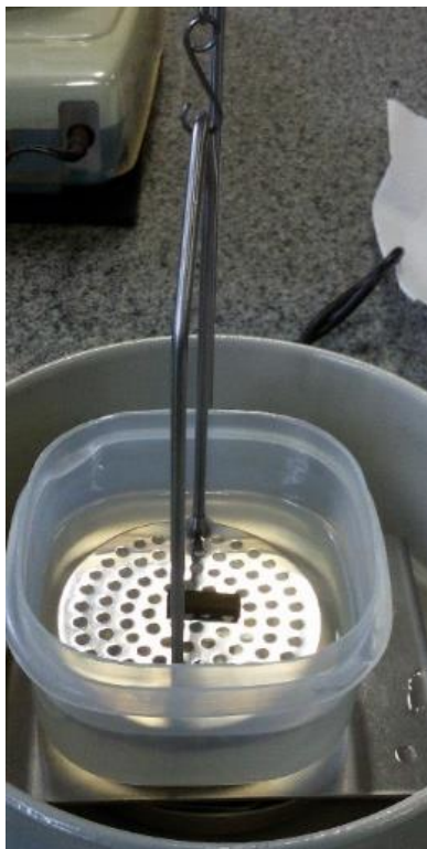
Figura 17: Balança hidrostática utilizada para a medição da massa imersa.
