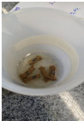
Figura 28 : Corpos de prova com substituição total do cimento por escória de alto forno
