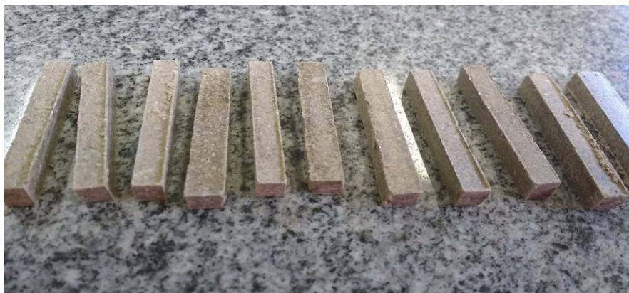
Figura 11: Alguns corpos de prova com composições variadas após prensagem
