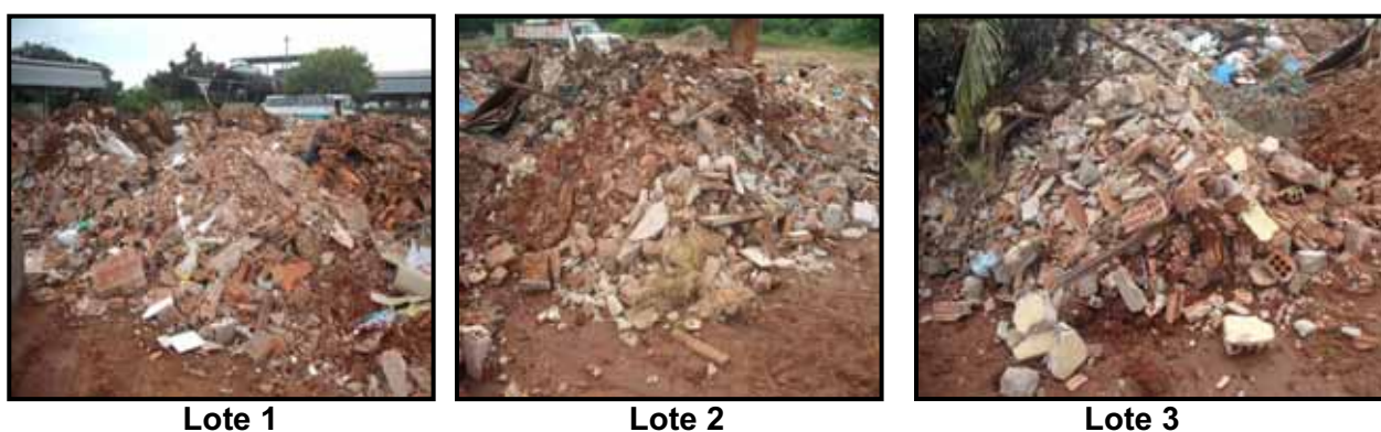
Figura 30: Lotes de RCD utilizados para retirada de amostras
