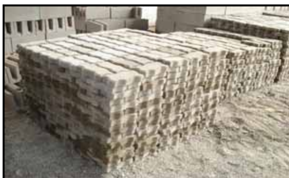
Figura 22: Produção de piso intertravado com utilização de agregado reciclado na usina de reciclagem de RCD no Município de São Carlos
