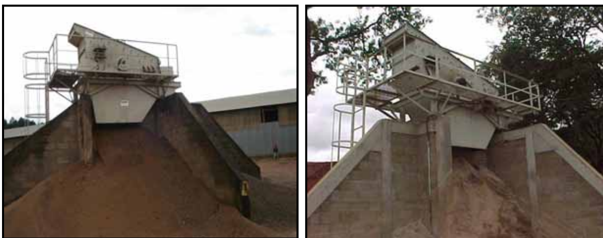
Figura 16: Peneira vibratória e depósito de agregados reciclados Fonte: Autor (2009)
