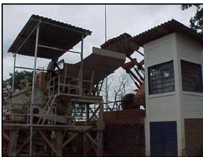
Figura 9: Alimentador vibratório abastecido por máquina pá carregadeira na usina de reciclagem de São José do Rio Preto Fonte: (Autor, 2009)
