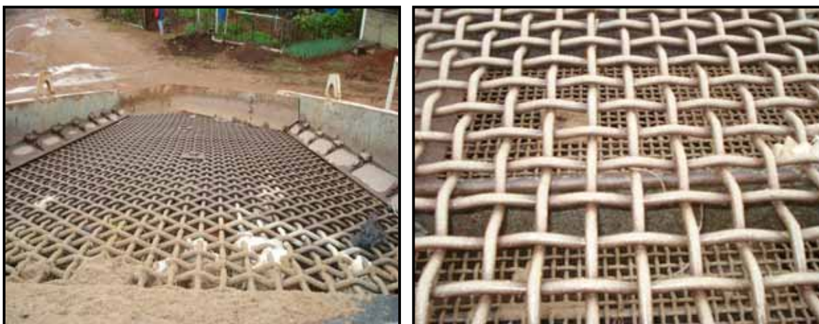
Figura 15: Malha para peneiramento e definição granulométrica Fonte: Autor (2009)
