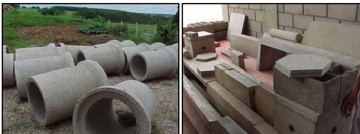
Figura 20: Tubos para galeria de águas pluviais, lajotas sextavadas e postes
