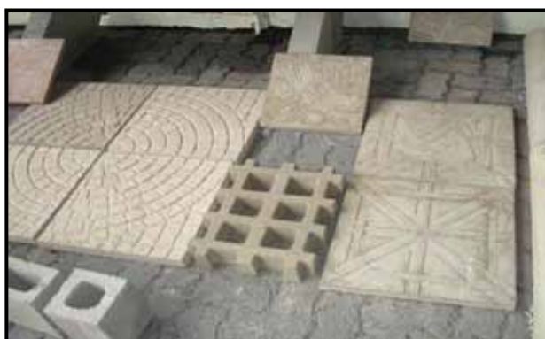
Figura 23: Produção de piso ornamental com utilização de agregado reciclado na usina de reciclagem de RCD do Município de São Carlos
