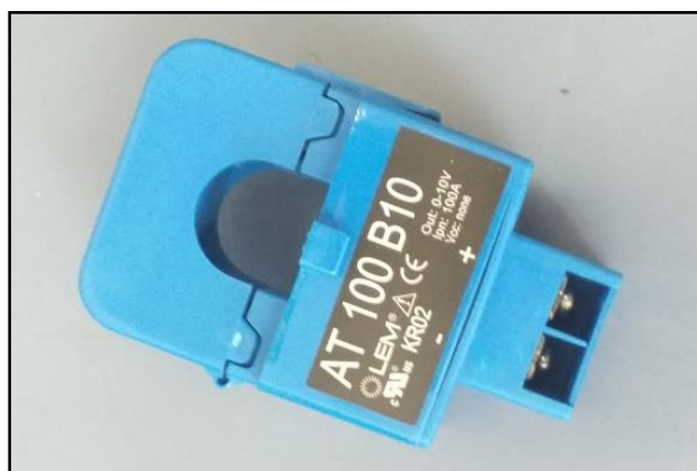
Figura 22 – Sensor utilizado para registro da potência.
