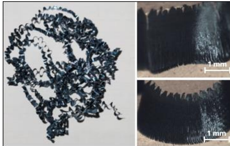
Figura 45 – Visualização macro e micro dos cavacos gerados.
