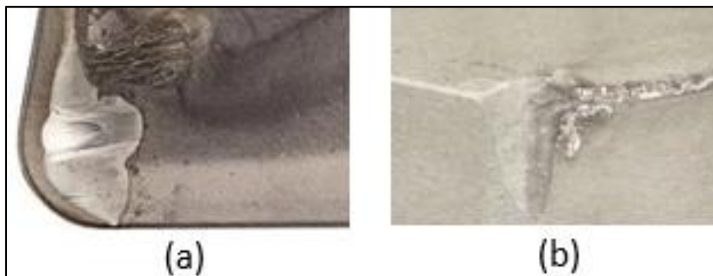
Figura 17 – Tipo de desgaste: (a) Desgaste de cratera; (b) Desgaste de entalhe.
