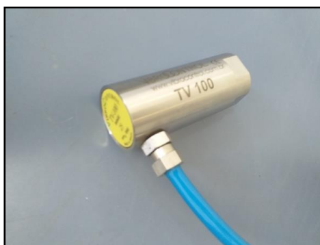
Figura 23 – Sensor piezelétrico, marca Vibro Control, modelo TV100.
