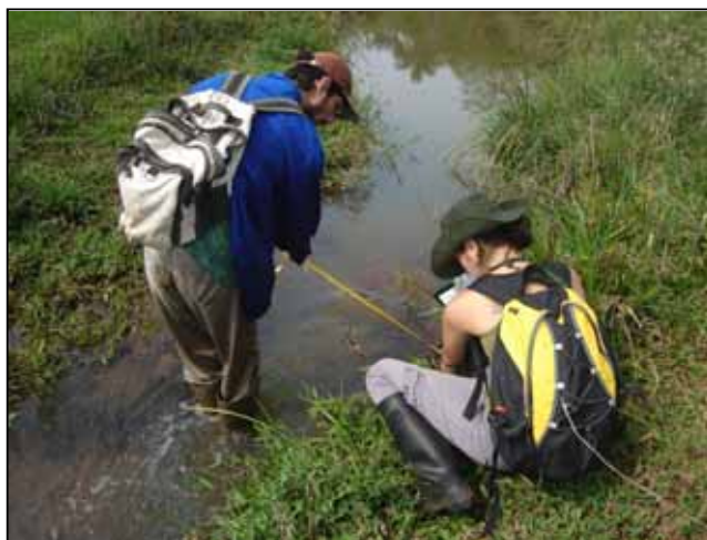
Figura 5. Obtenção de medidas de profundidade e largura do canal.
