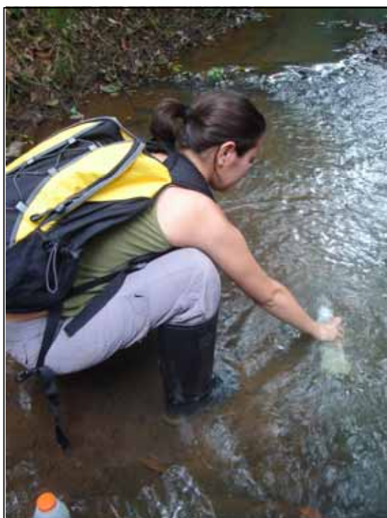
Figura 6. Coleta de amostras de água nos pontos de vertedouro.
