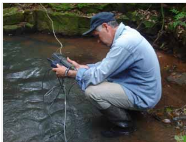
Figura 4. Obtenção de medidas físicas da água utilizando o equipamento Water quality Checker.
