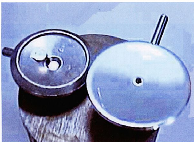
Figura 3.17 – Geometria interna dos receptáculos: nacional e americano
