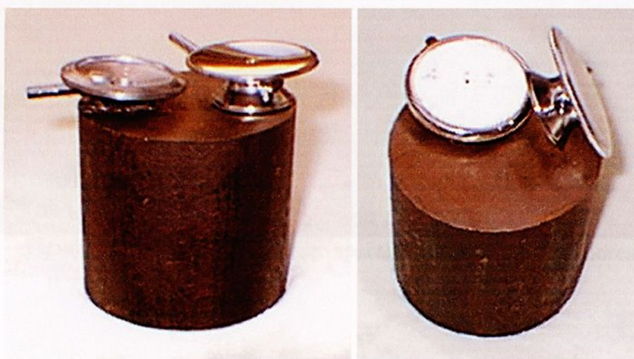
Figura A.1 – Fotografia da campânula do estetoscópio nacional colada em base pesada (a esquerda das fotos) e o receptáculo do estetoscópio americano com campânula e receptor de diafragma (lado direito das fotos)
