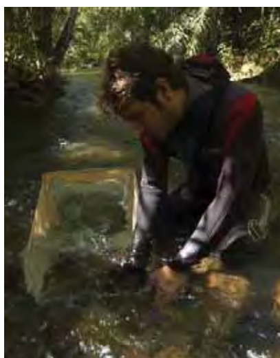
Figura 1. Vista geral do procedimento para amostragem de macroinvertebrados bentônicos com rede Surber. Foto: Daniel W. Xavier.
