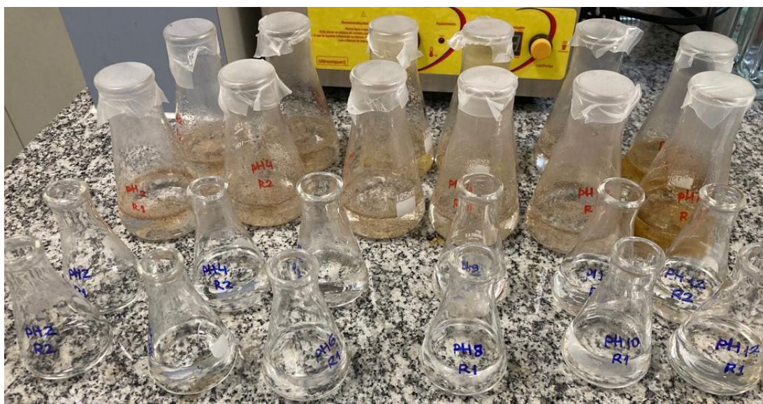
Figura 4 – Amostras de BM e BM encapsuladas distribuídas em erlenmeyers para determinação de potencial de carga zero.
