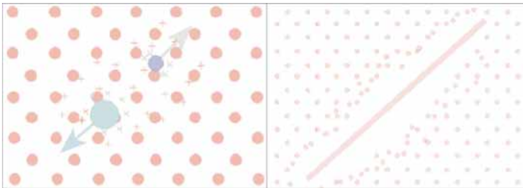
Figura 3.2: Processo de formação do traço de fissão (modificado de Wagner & Van den Haute, 1992)
