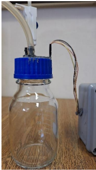
Figura 7. Sensor de CO 2 utilizado no biorreator de bancada.
