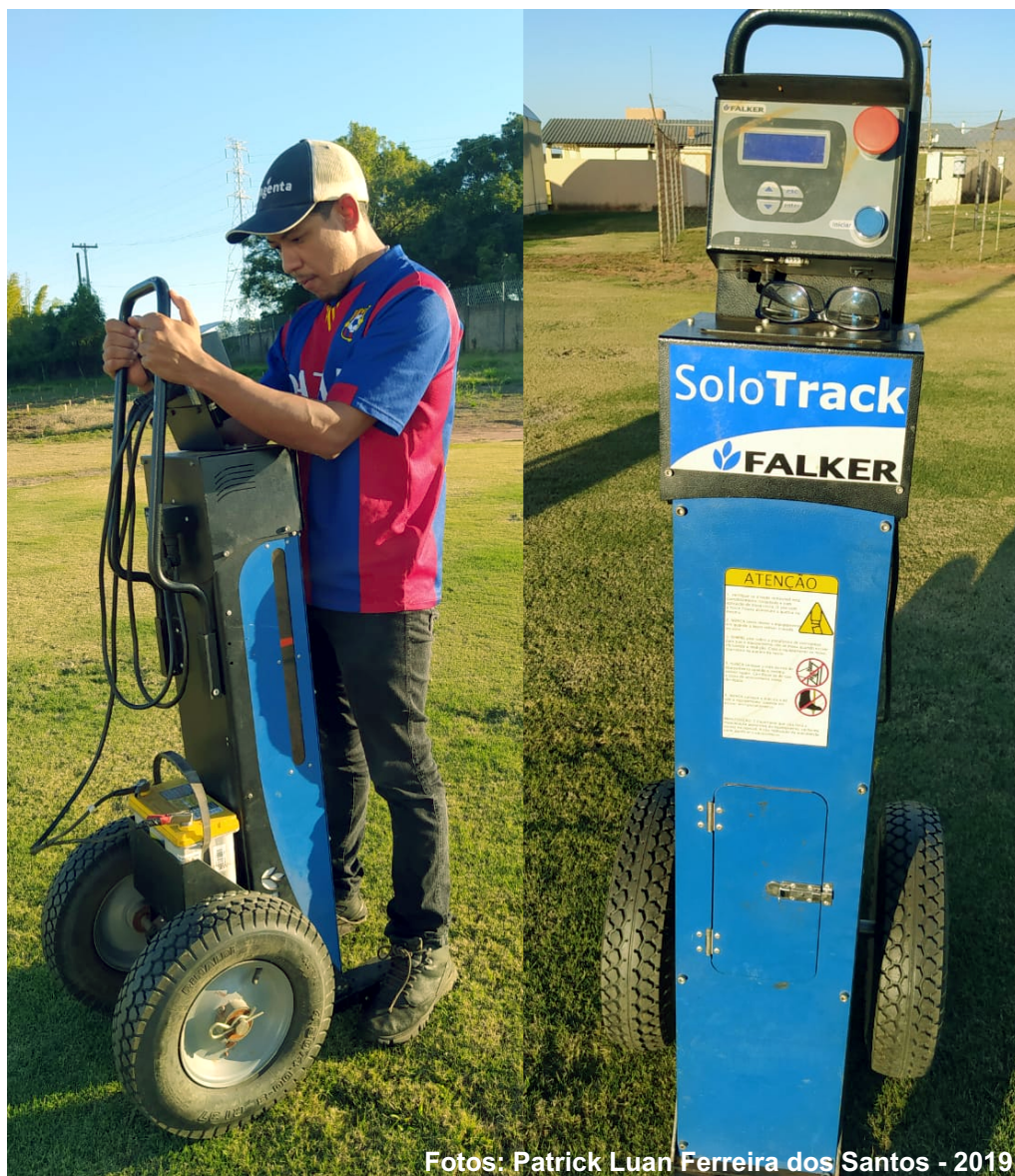
Figura 10 - Avaliação da resistência mecânica a penetração do solo (Botucatu-SP 2019-2020)
