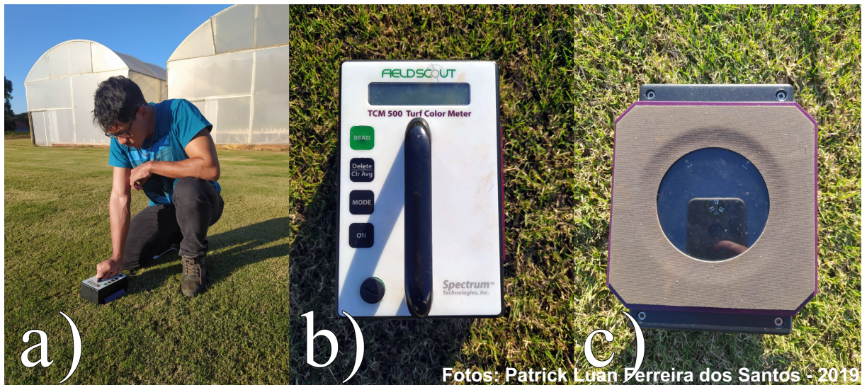
Figura 13 - a) Avaliação do gramado com Field Scout TCM 200. b) Detalhe do aparelho. c) Detalhe do leitor de contato com a grama para realização da leitura. (Botucatu-SP 2019-2020)
