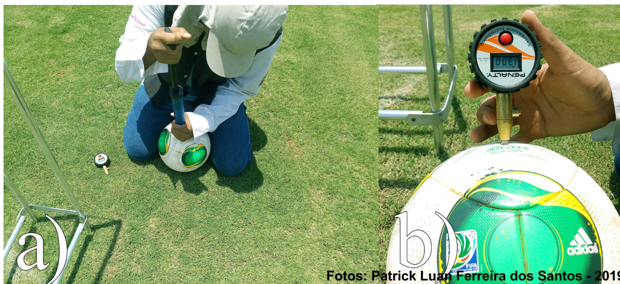
Figura 18 - Calibração da bola oficial da FIFA (Cafusa-Adidas®) para mantê-la a pressão de 13 psi. (Botucatu-SP 2019-2020)
