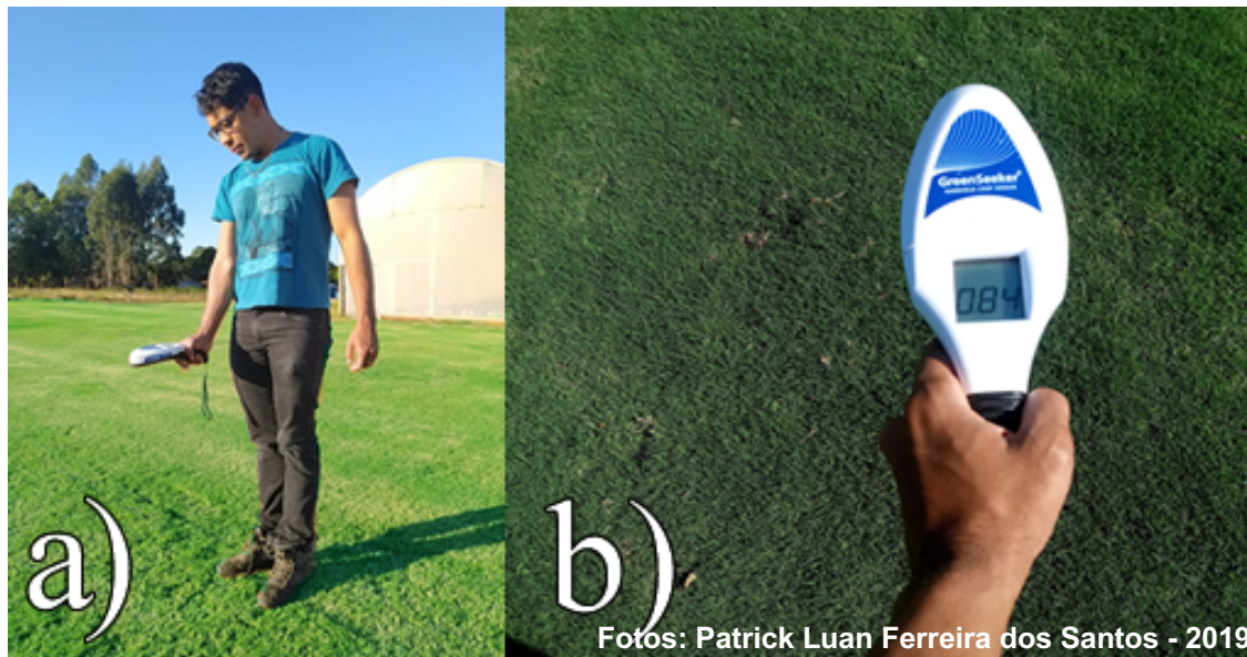
Figura 11 - a) avaliação do NDVI como aparelho GreenSeeker. b) Detalhe do valor encontrado no aparelho GreenSeeker após avaliação. c) Princípio do funcionamento do aparelho GreenSeeker.
