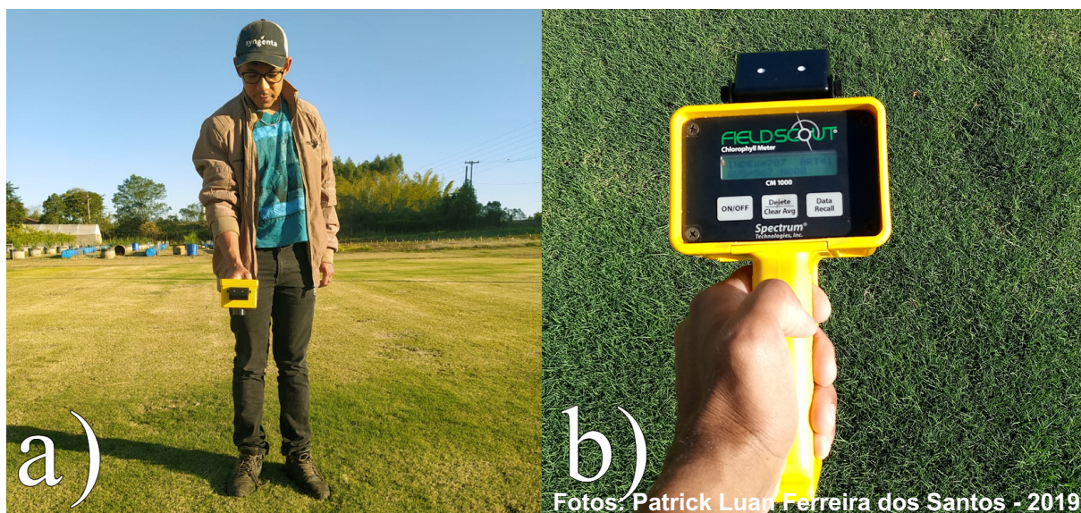
Figura 12 - a) Avaliação do índice de cor verde. b) Detalhe do aparelho Field Scout CM1000 (Botucatu-SP 2019-2020)
