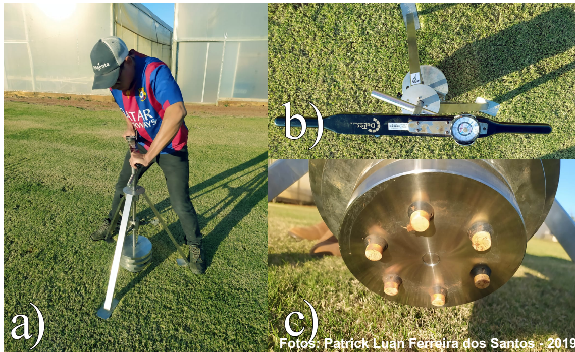
Figura 15 - a) Avaliação da resistência do gramado a tração. b) Detalhe do aparelho Rotational Resistance Tester. c) Cravo que “rasga” o gramado para realização da avaliação. (Botucatu-SP 2019-2020)
