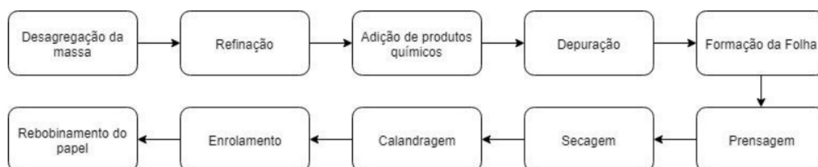
Figura 8 - Etapas da produção de papel a partir da massa celulósica.
